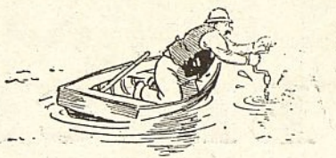
Con un berbluq hacer un agujero de dos pulgadas de diámetro.
