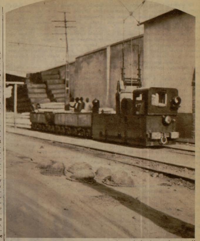
Locomotora eléctrica para el transporte de mineral desde el pozo de extracción al cerco de destilación
