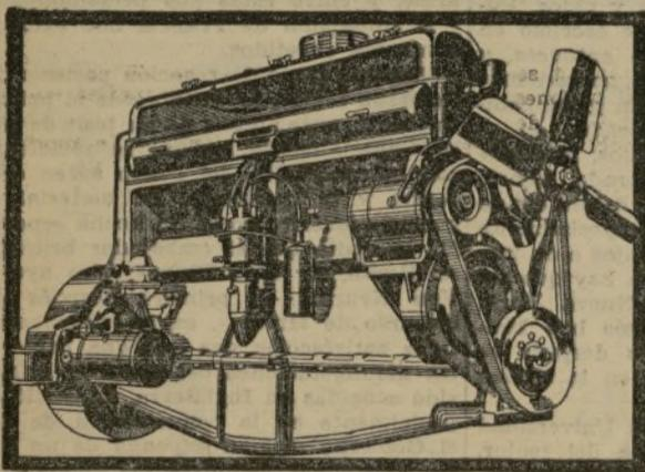
Los chasis T-18, T-23, T-33, T-43 y T-46 tienen motores de 6 cilindros de válvulas en cabeza especialmente diseñados por Buick para camión, de 77, 83 ó 94 H. P. según el modelo, muy perfeccionados para 1935 en especial en cuanto a su economía.
