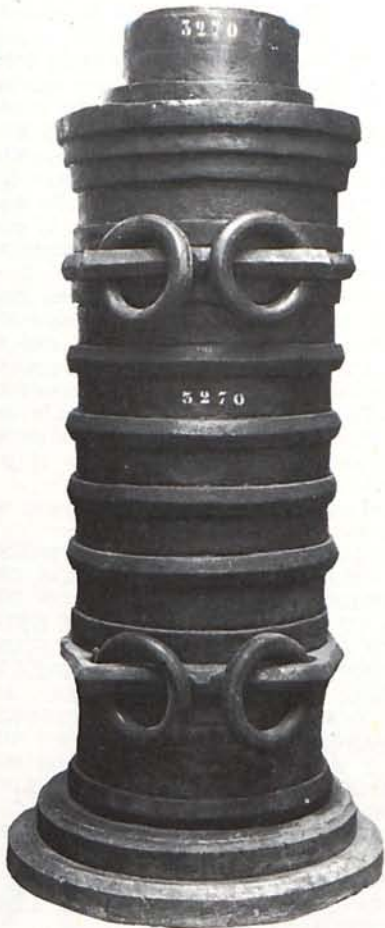
Recámara de bombard de 20,5 cm. de calibre por 139,5 de longitud total, siendo, por tanto, una de las mayores de la segunda mitad del siglo XV. Perteneció a la artillería del Rey Católico y se utilizó en la conquista de Baza, de donde procede. (Museo del Ejército.)
