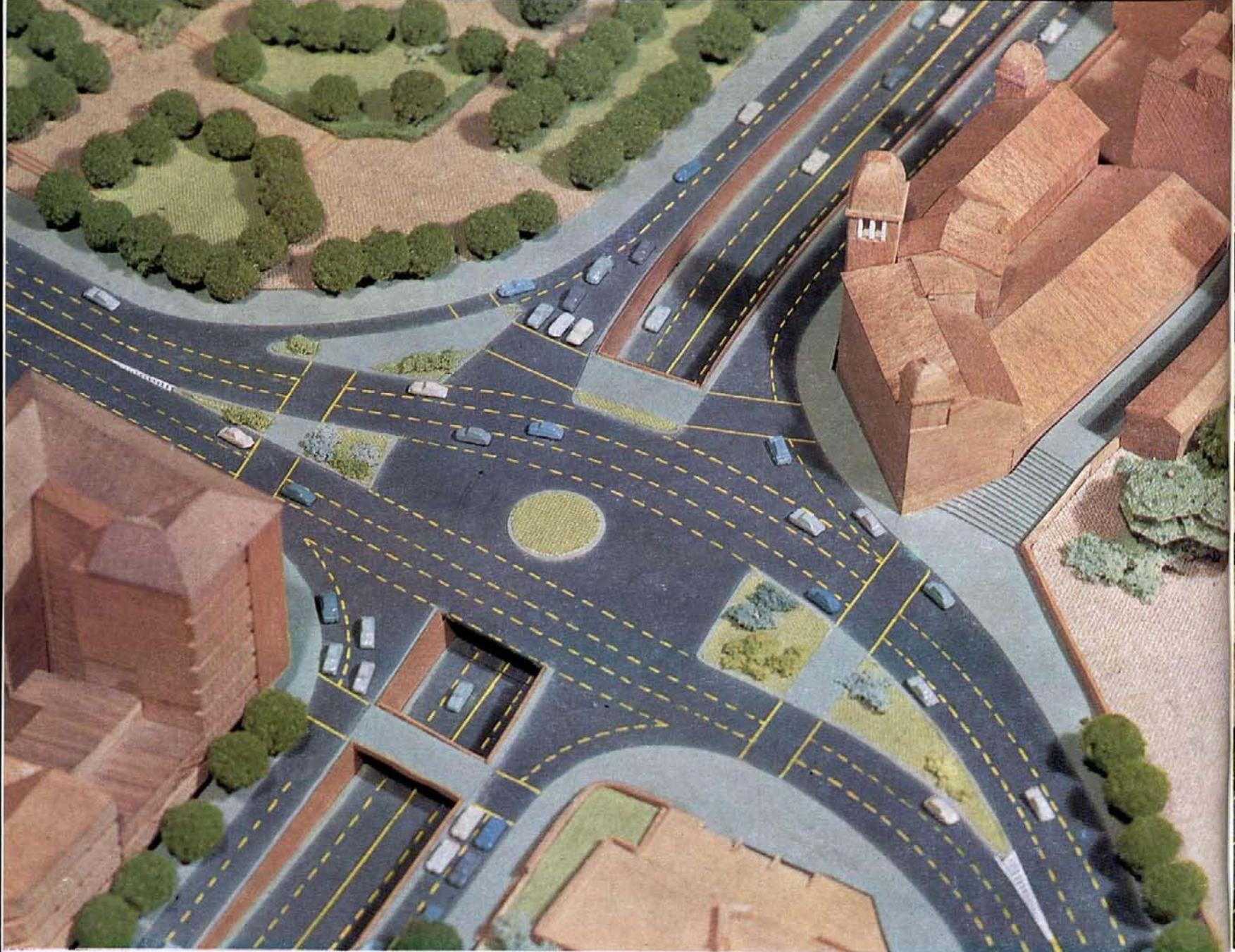
*Paso a distinto nivel Bailén-Ferraz con Onésimo Redondo, visto de cerca para que puedan apreciarse los pasos de peatones, carriles de circulación, tolva del paso inferior, etcétera.*
