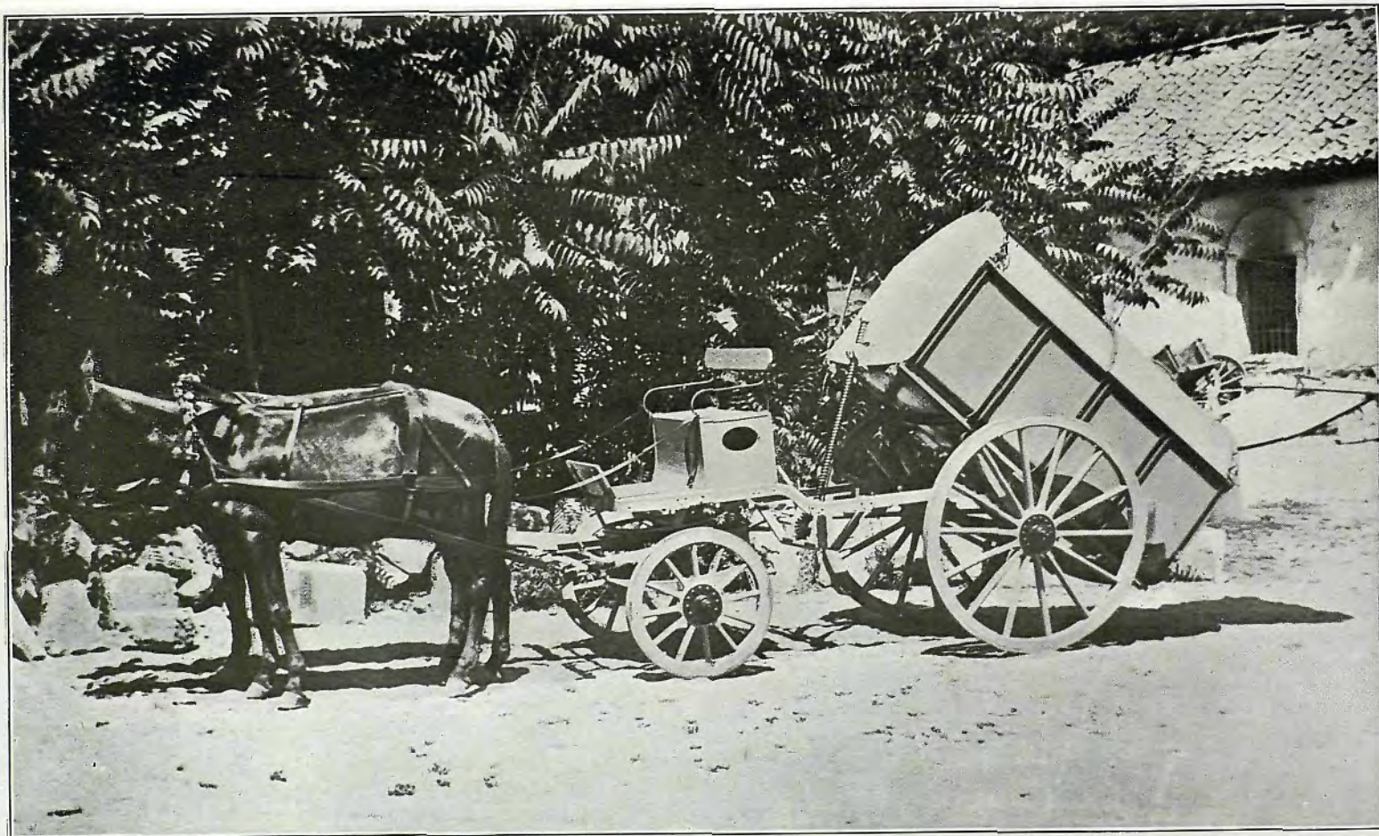
El sistema de vaciado en el nuevo modelo de carro metálico.
