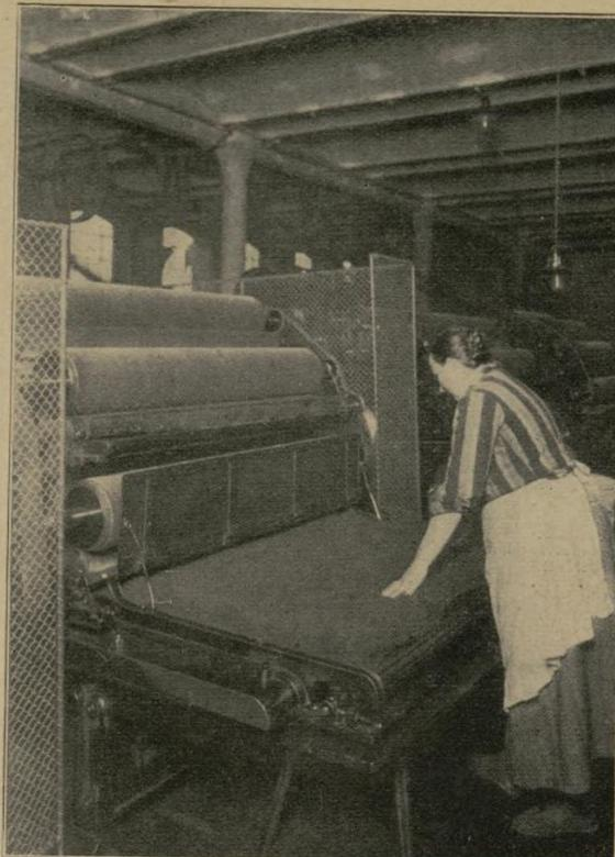
Fig. 2: Primer trabajo de la lana con la carda curtidora.
