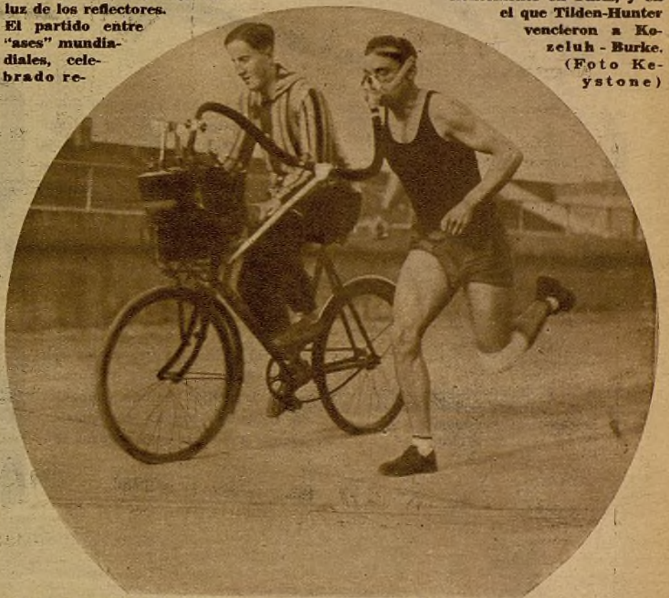
EL ATLETISMO "CIENTIFICO". —Aparato registrador del consumo de óxido carbónico que realiza un corredor pedestre en pleno esfuerzo
