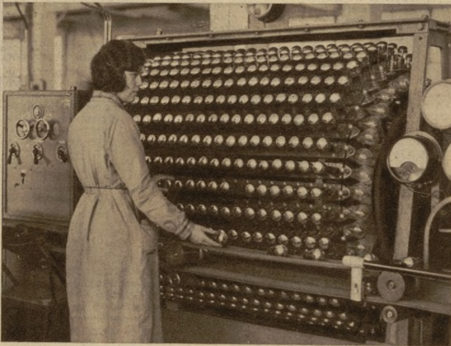
Banco de comprobación de válvulas de radio. Su forma especial de tambor giratorio permite comprobar con rapidez gran número de válvulas
