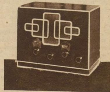
■ **R-151 Superheterodino** de 4 válvulas para corriente alterna. Dos de estas válvulas son de "doble efecto": de este modo el rendimiento de las cuatro equivale al de seis en un aparato sencillo. Trabaja con un voltaje de 105 a 125, 50/60 periodos. Consumo mínimo de 40 vatios. Lleva altavoz electrodinámico, control de tono y cuadrante de estaciones iluminado. Precio: 395 pesetas.
