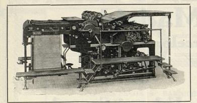
Modelo 1929, provisto de rectificador automático, que garantiza el más absoluto registro de la hoja, a una velocidad de 3.000 impresiones por hora
