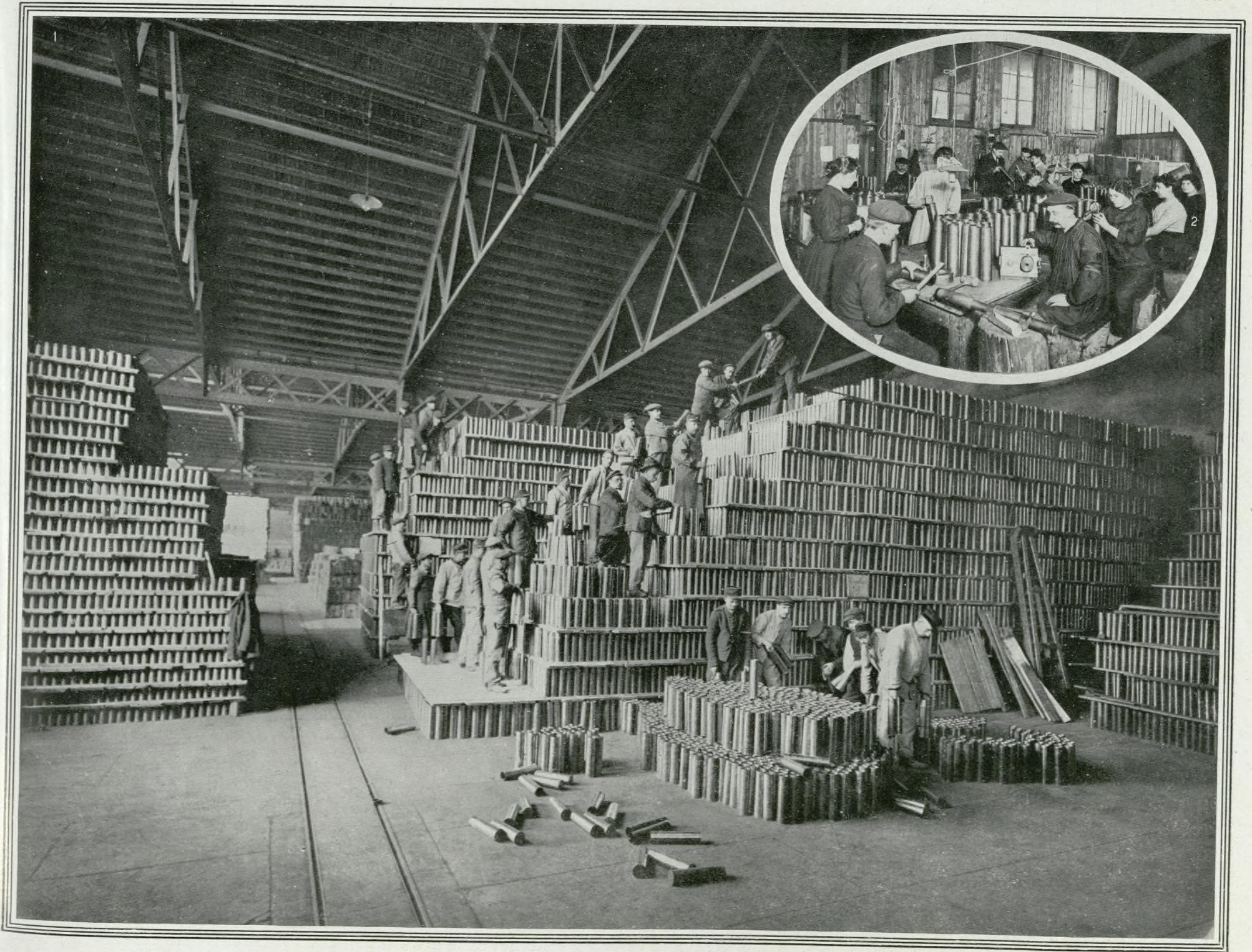
1. Empilage des douilles de 75. — 2. Vérification finale des douilles.
