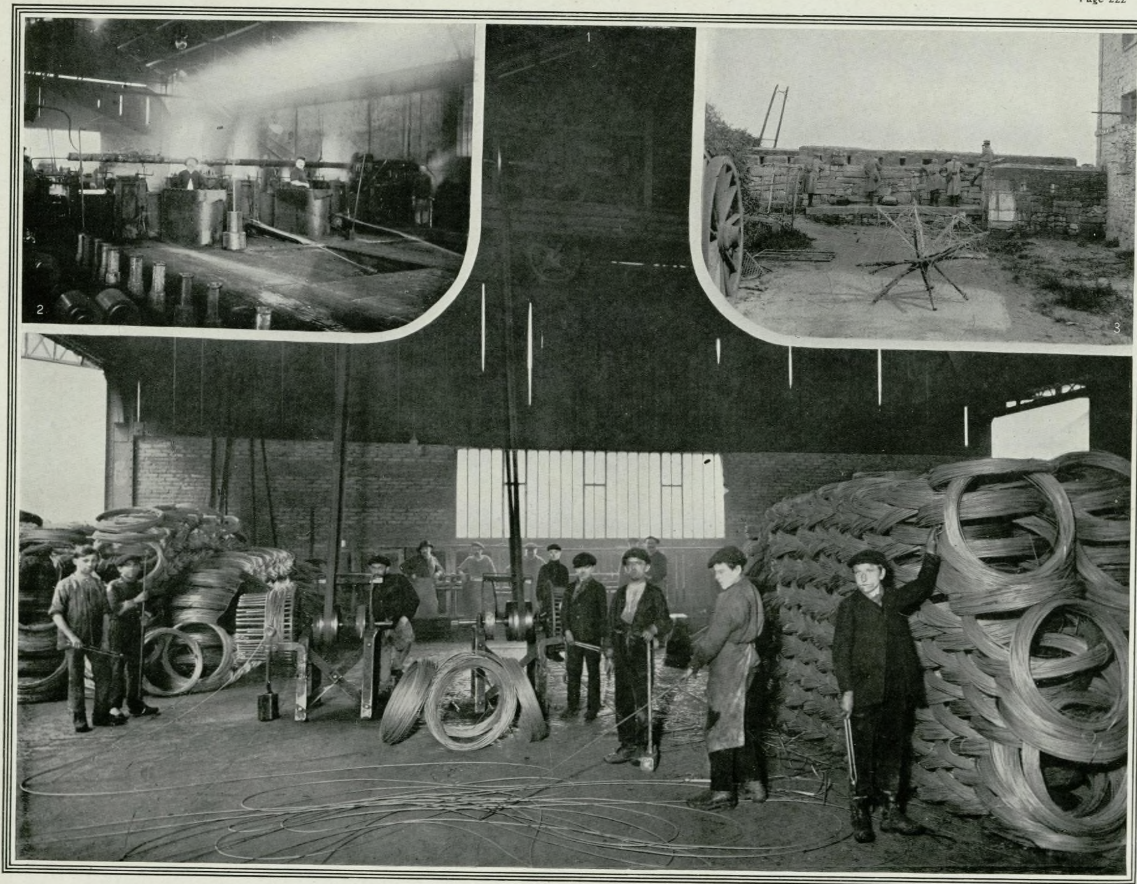
Fabrication du fil de fer : 1. Enrouleur de fil. — 2. Laminoir. — 3. Araignée de fil de fer, un des éléments d'organisation défensive. Ayuntamiento de Madrid
