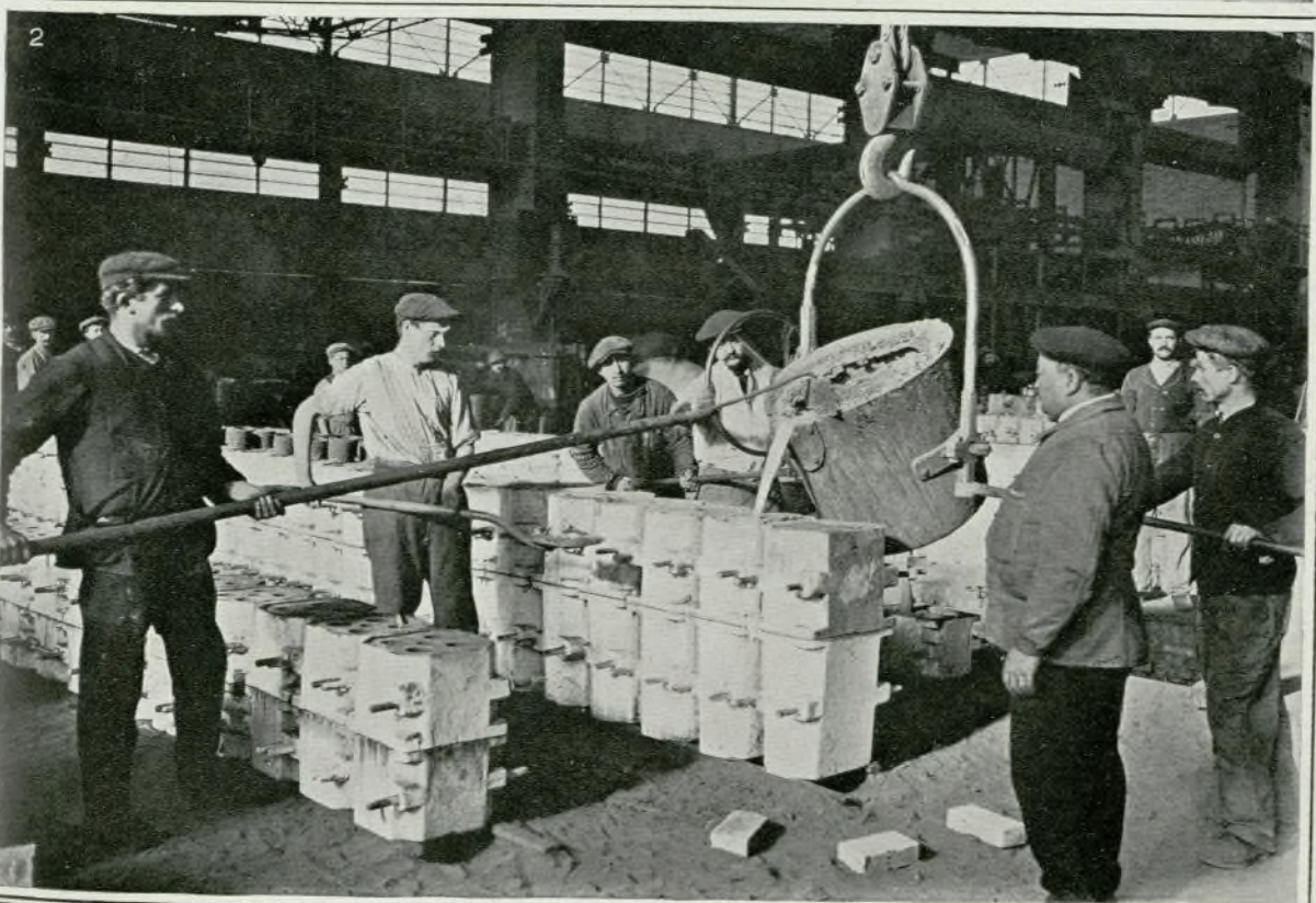
1. Cubilots; le chargement. — 2. Coulée dans les moules. — 3. Coulée de gueuses.
