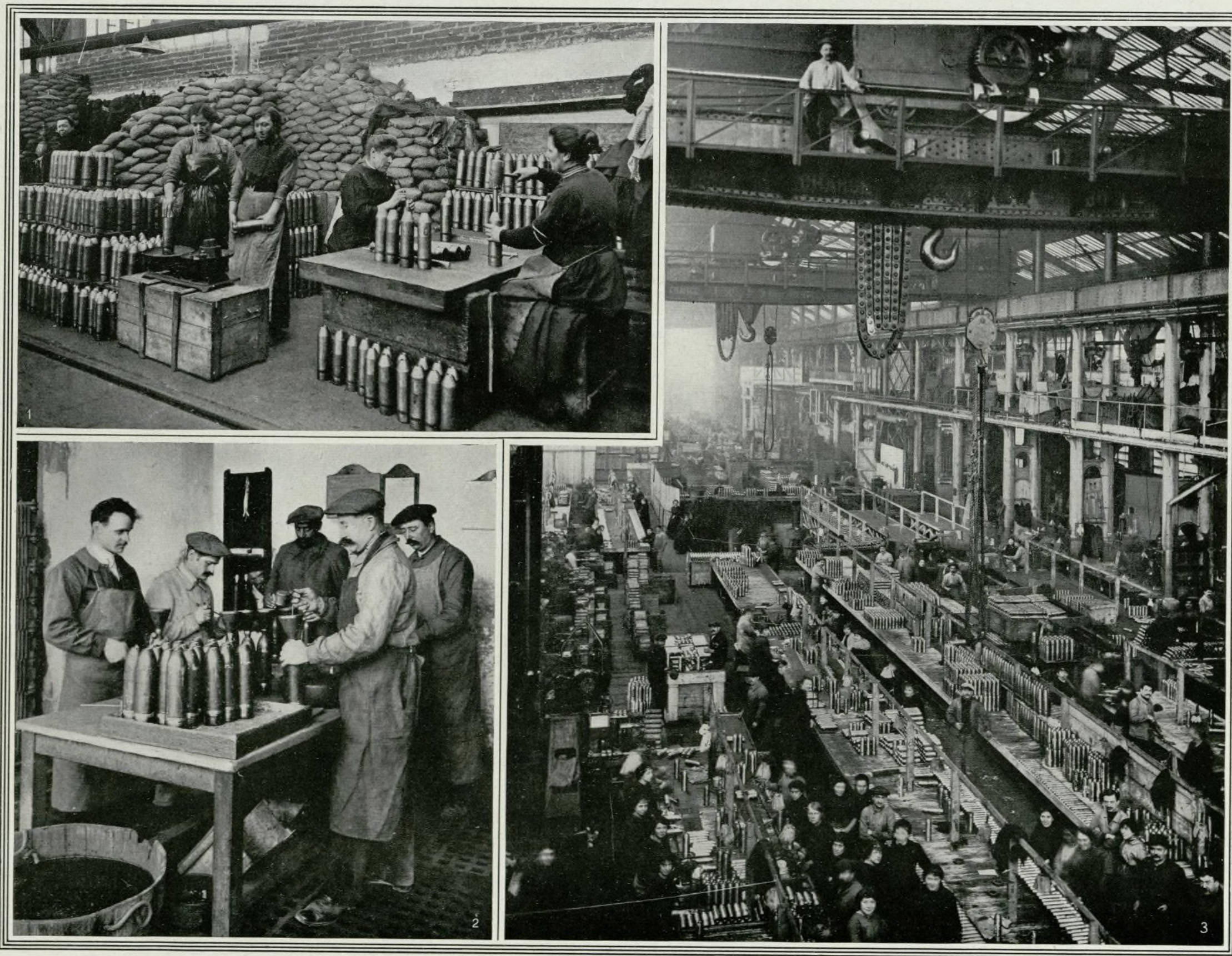
1. Pesage de l'obus plein et nettoyage. — 2. Chargement des obus. — 3. Un atelier de vérification des obus. Ayuntamiento de Madrid
