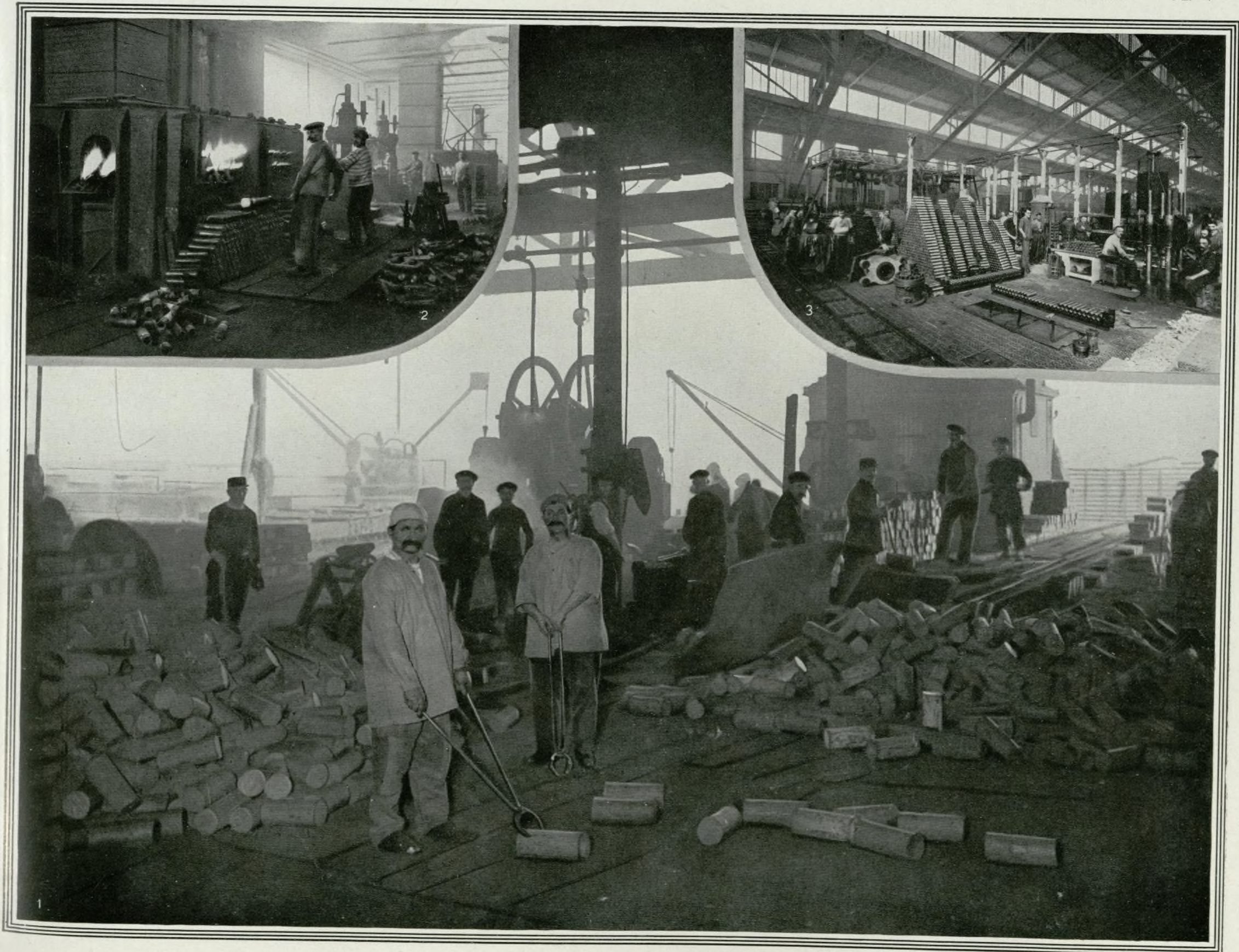
1. Atelier de finissage du Grand Mill. — 2 et 3. Ogivage des obus de 75 explosifs. Ayuntamiento de Madrid
