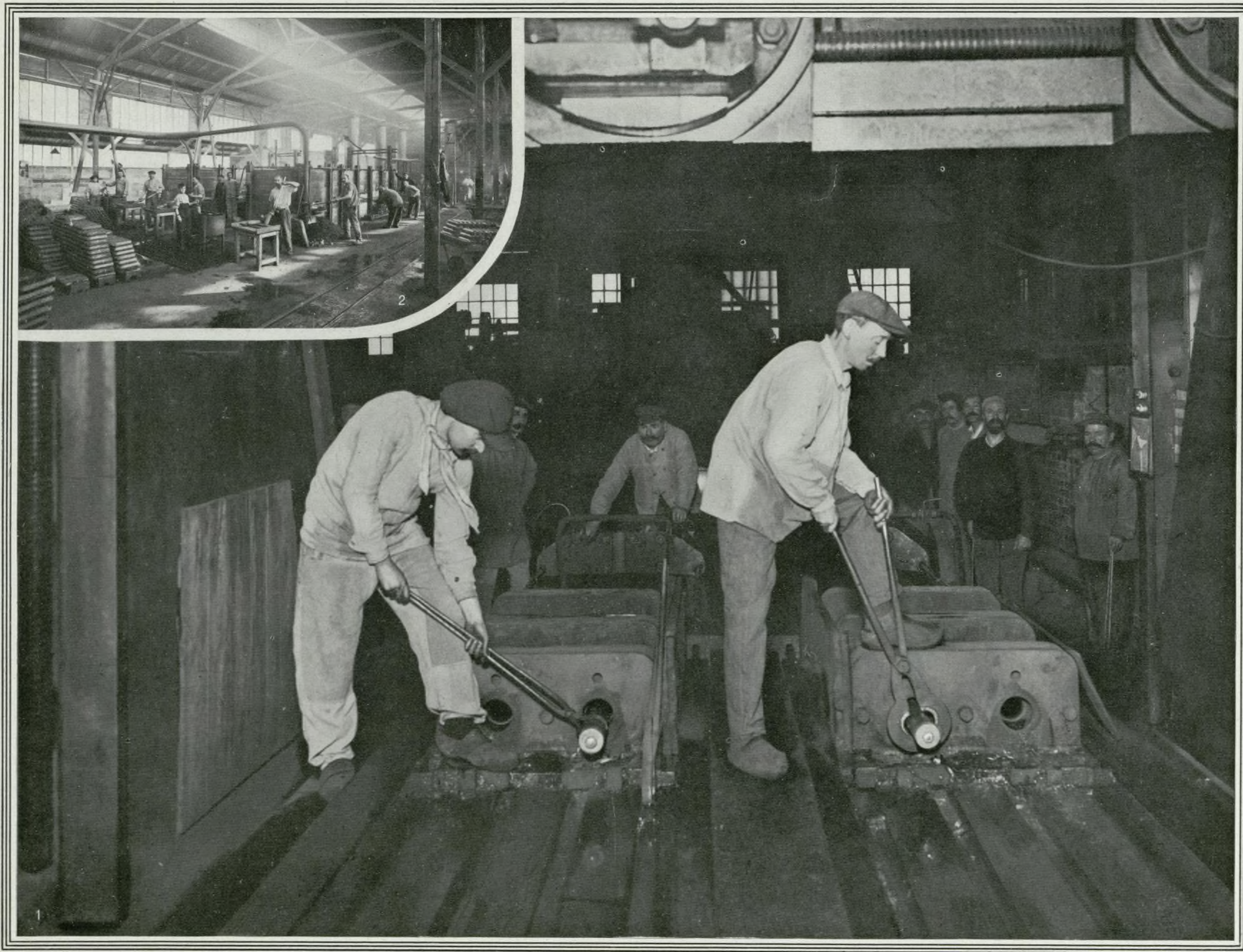
1. Tréfilage d'obus de 75 au rabot. — 2. La trempe des obus de 75 ; les fours. Ayuntamiento de Madrid
