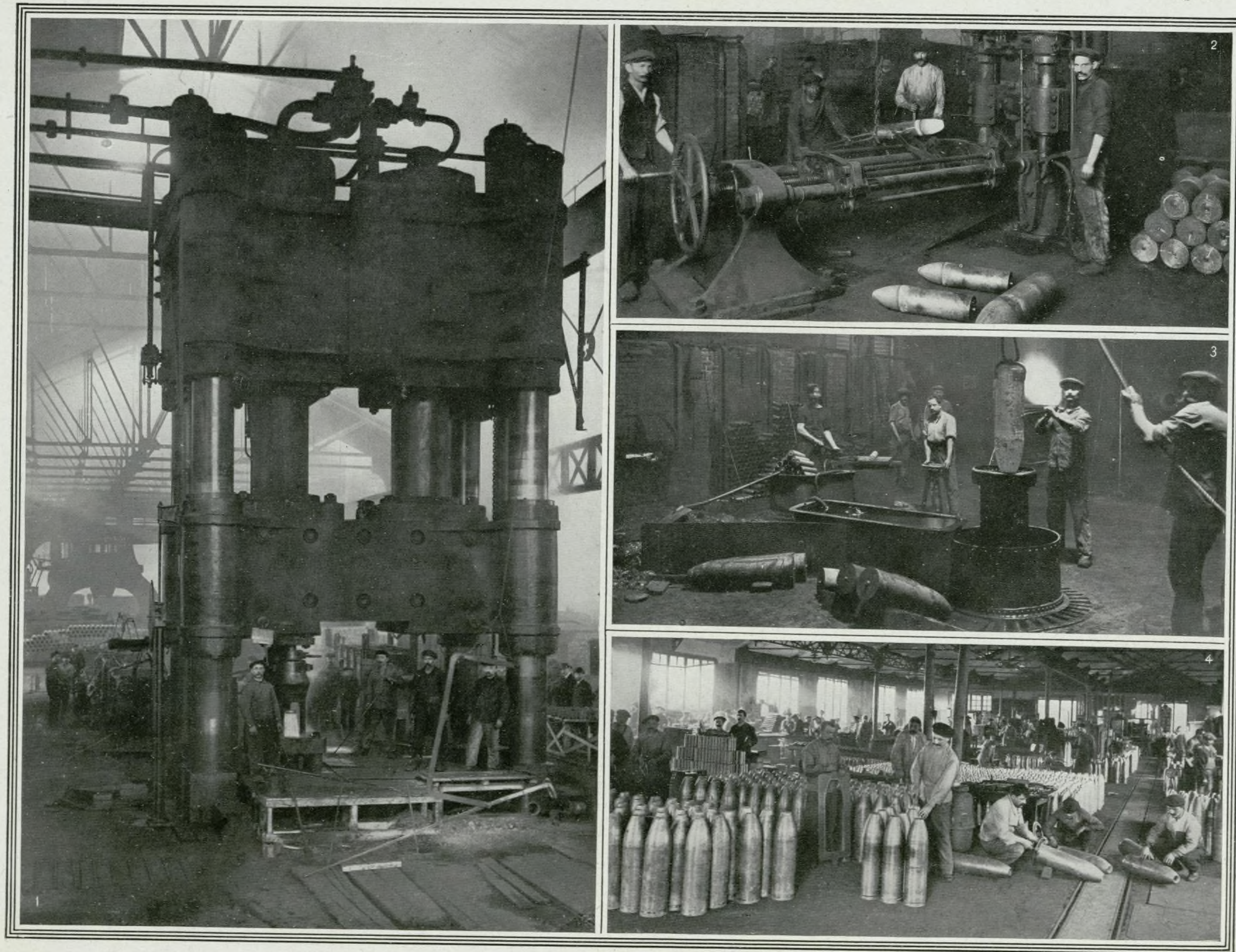
1. Grosse presse de 6.000 tonnes. — 2. Ogivage des obus de 155. — 3. Trempe des obus de 220 et 75. — 4. Le contrôle des obus.
