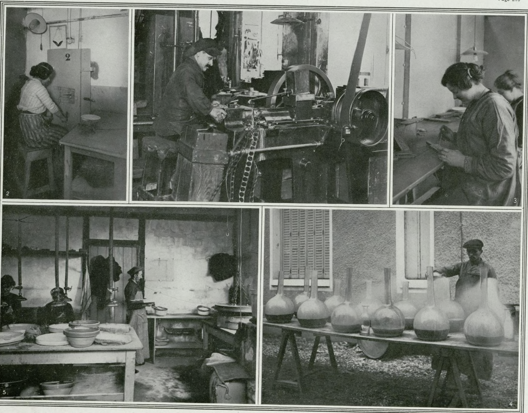
1. Fabrication de l'amorce à collerette pour fusée 24×31 : emboutissage. — 2. Chargement des amorces 24×31. — 3. Préparation à main des amorces de 90. 4. Préparation du fulminate de mercure et chargement. 5. Lavage du fulminate.
