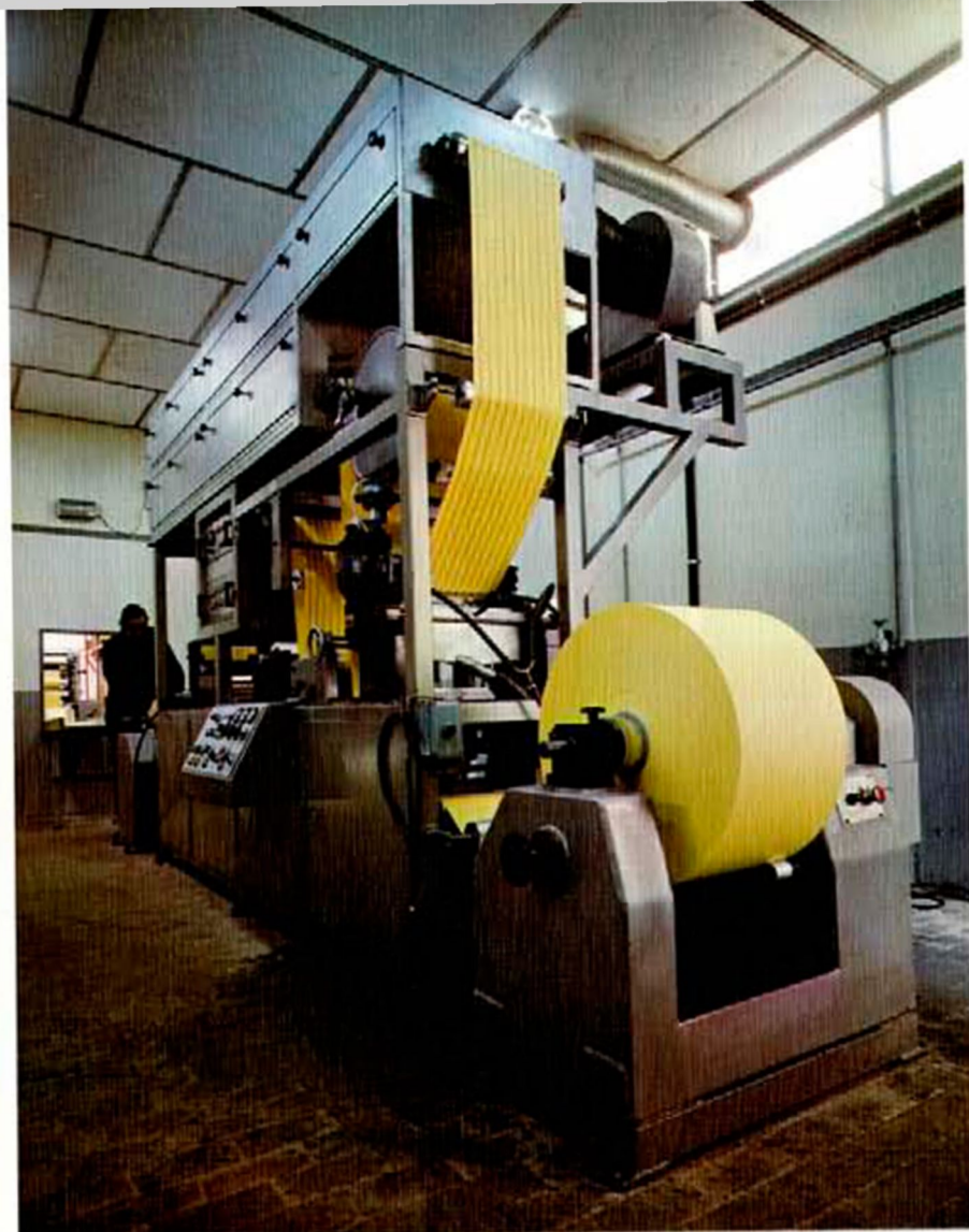
Máquina para la fabricación de billetes magnéticos.
