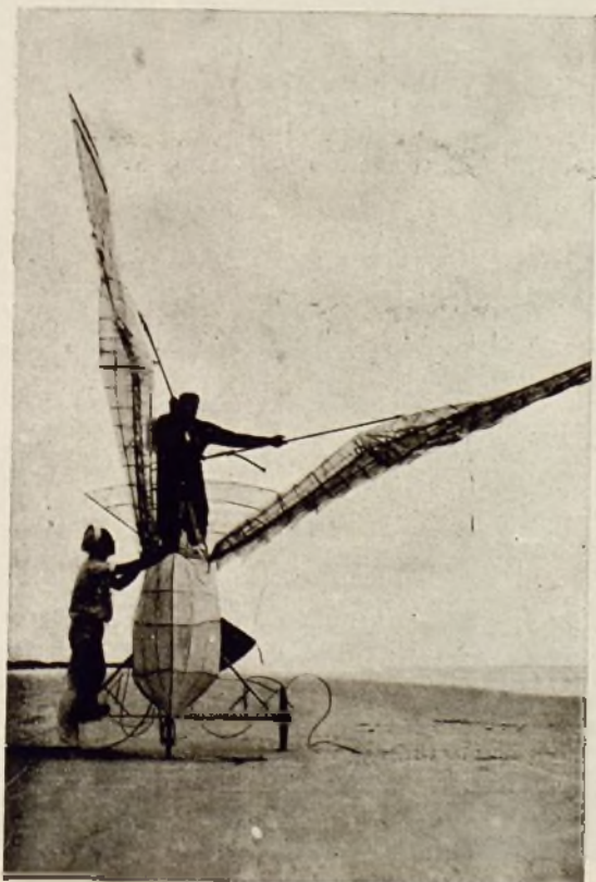
Aparato volador inventado por un norteamericano y en cuya forma se ha imitado el aspecto de la gaviota. El mecanismo no dispone de motor, funcionando mediante el movimiento de las alas.
