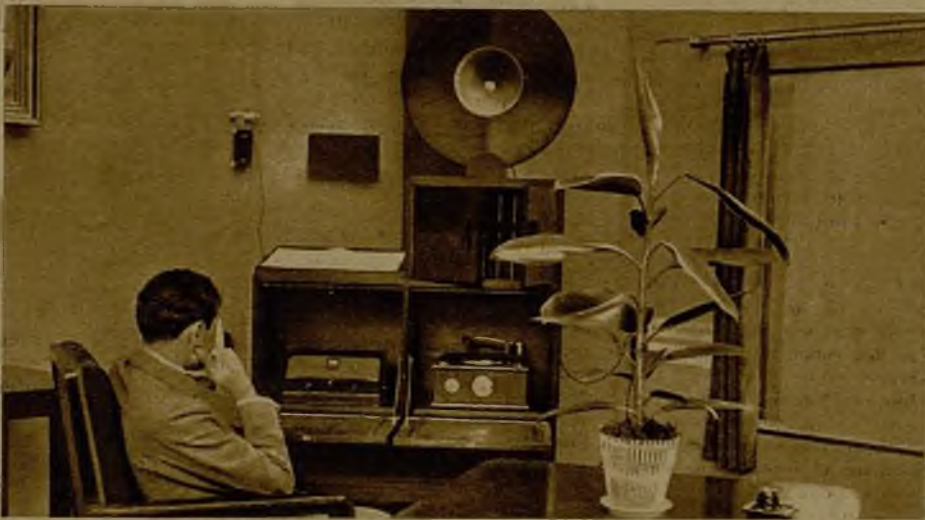
Senillo armario de música que cualquier radioaficionado puede construir, reuniendo en un mueble el aparato de radio y el reproductor fonográfico
