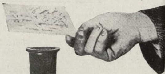
Las soluciones de sulfato de cobre proporcionan tintas simpáticas que se hacen visibles al someter la escritura a la acción de los vapores de amoníaco.
