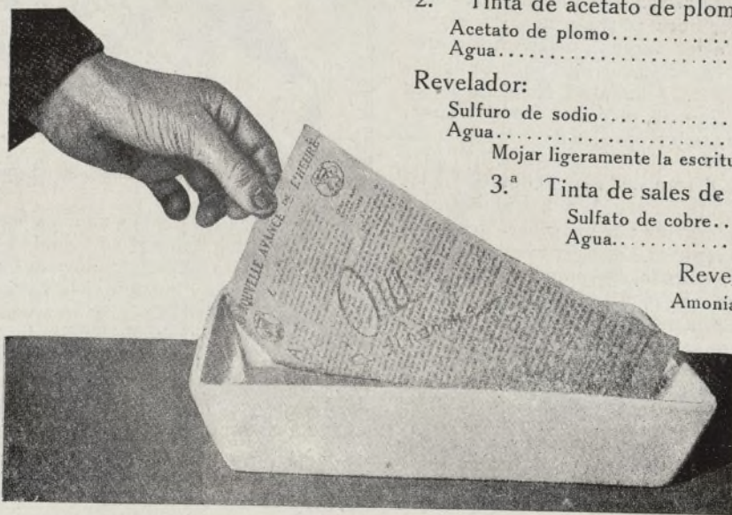
Los caracteres trazados con soluciones de nitrato de bismuto se vuelven negros metiendo el papel en una solución de sulfuro de sodio.
