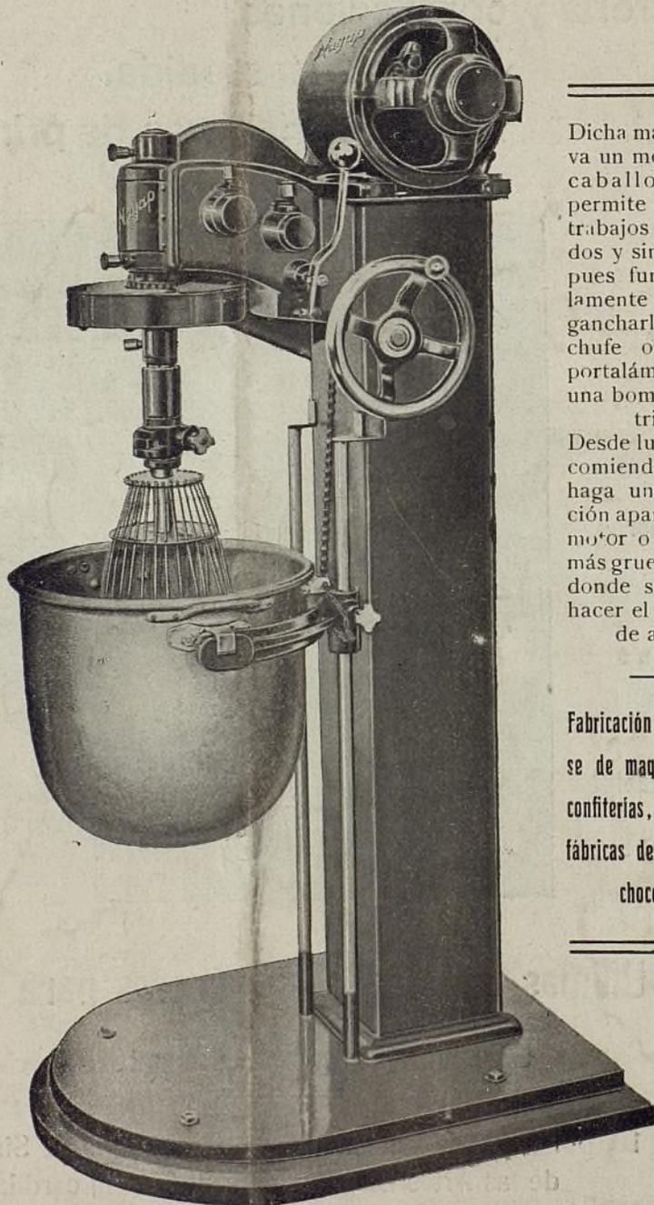
Dicha máquina lleva un motor de un caballo, el cual permite que sus trabajos sean rápidos y sin esfuerzo, pues funciona solamente con engancharla a un enchufe o bien al portalámparas de una bombilla eléctrica.
