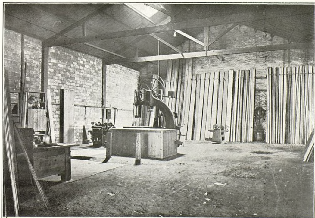
Sección de maquinaria de la casa de la Viuda de José Carreras. En ese departamento se fabrican molduras para la ebanistería, para cuadros y para el ramo de carpintería, así como el machiembrado o entarimado de todas clases, especialmente con las maderas más finas.
