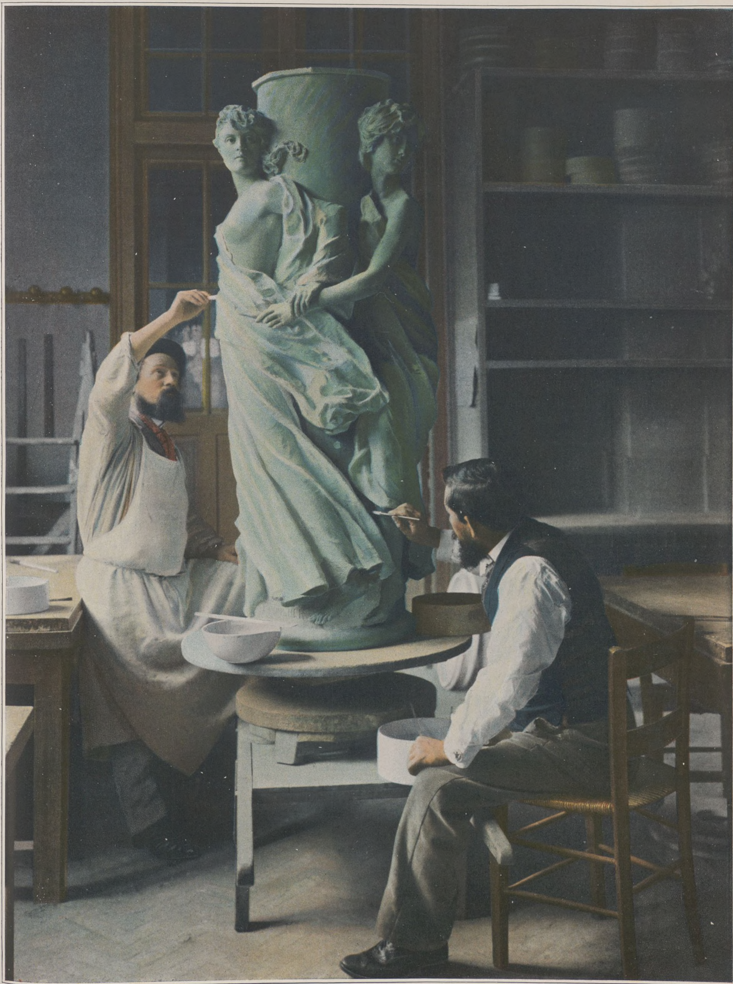
A SÈVRES. — UN ATELIER D'ÉMAILLEGE. — La mise en couverte colorée d'une colonne de fontaine, figures d'Alfred Boucher
