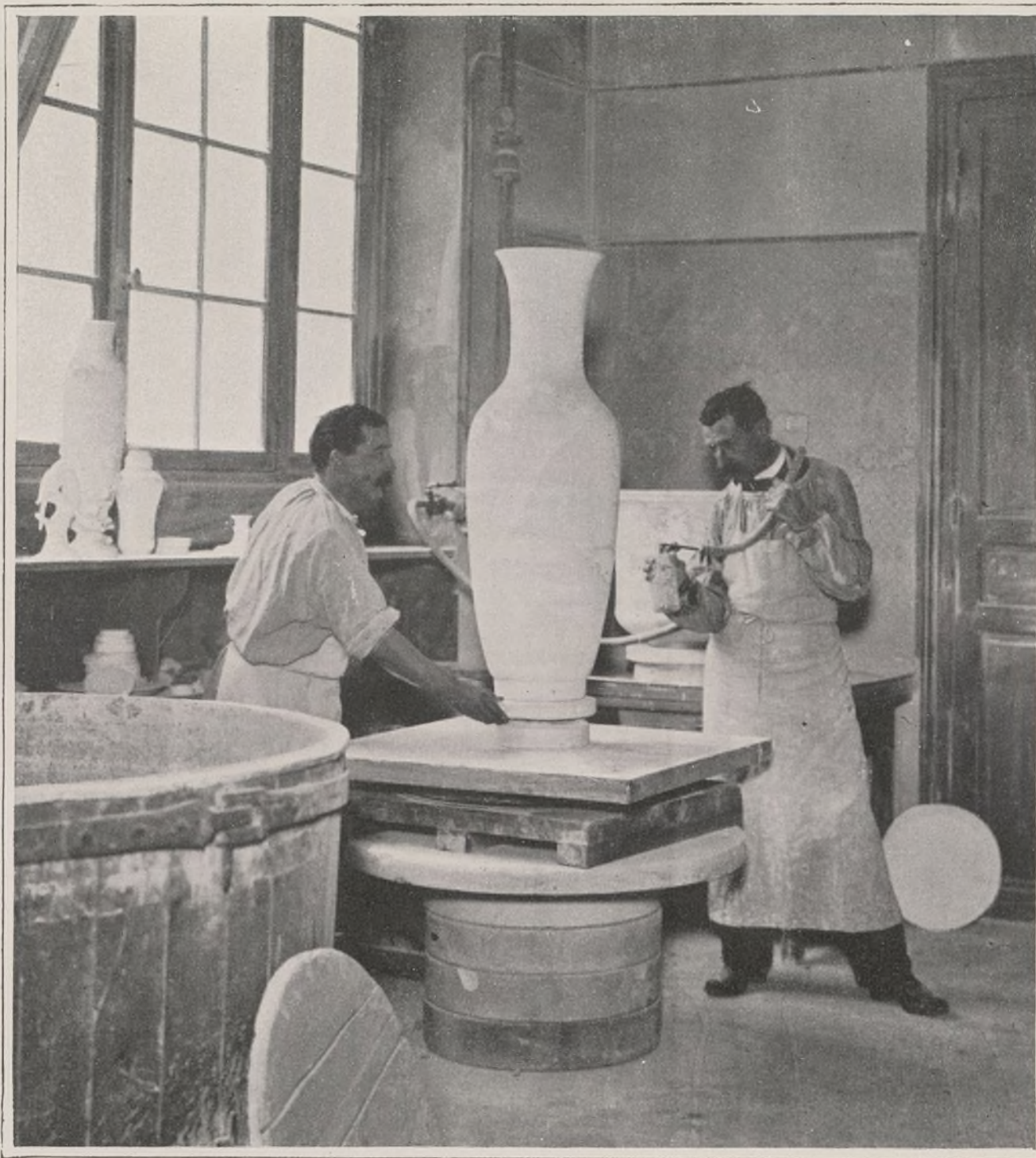
A LA MANUFACTURE DE SÈVRES. — L'ÉMAILLE PAR INSUFFLATION
