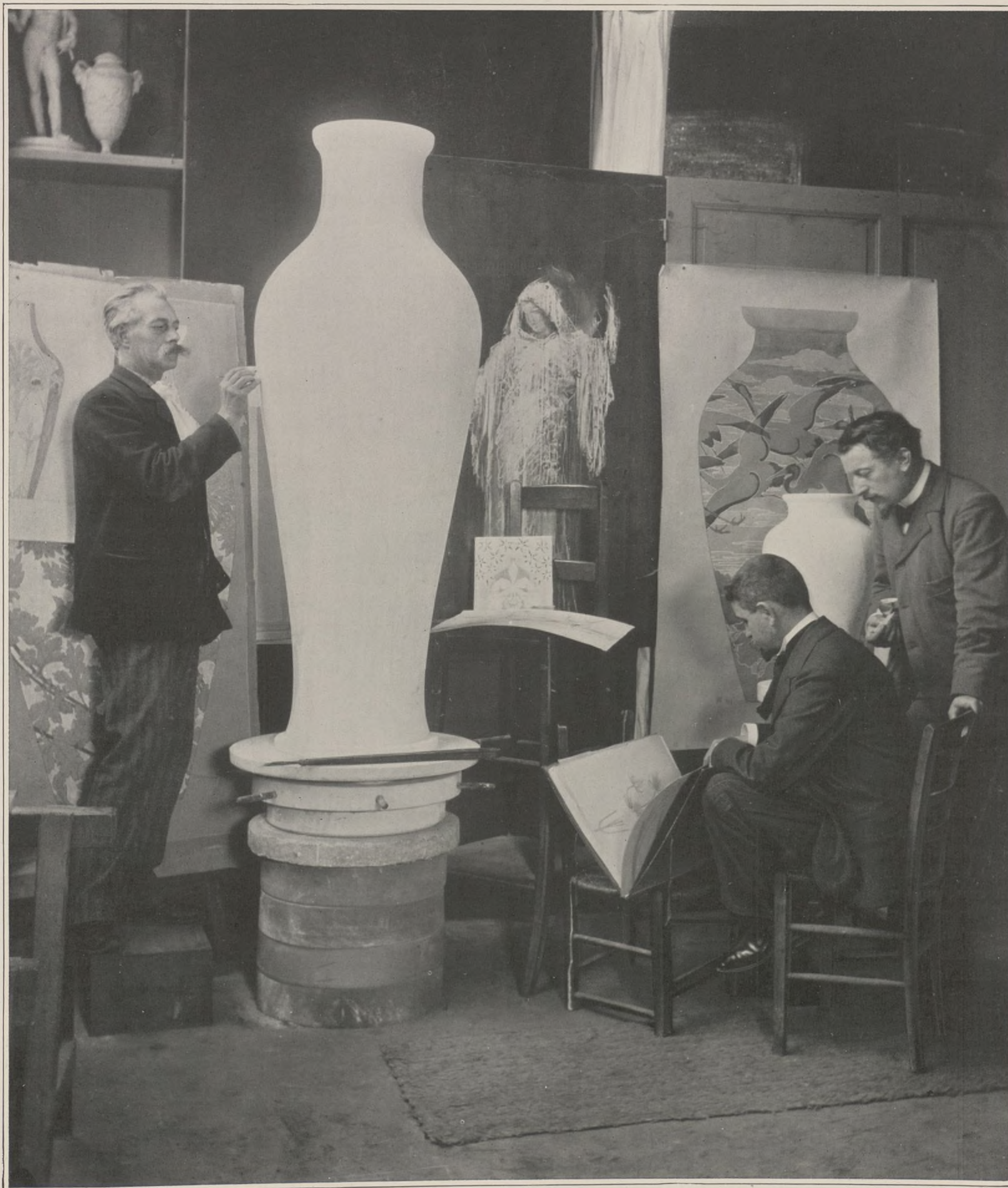
A SÈVRES. — UN ATELIER DE DÉCORATION La décoration sur cru, gravure et couvertes juxtaposées
