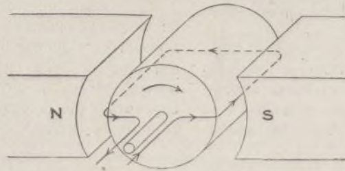
Fig. 4.—Dirección de la fuerza de la armadura.
