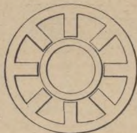
Fig. 7.—Máquina de ocho polos equivalente al imán fig. 6.
