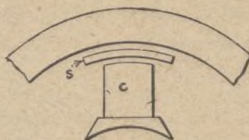
Fig. 11.—Interposición de una pieza de acero entre el núcleo y el yugo.
