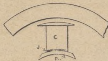
Fig. 12.—Otra forma del tipo anterior; la chapa interpuesta forma una sola pieza con el núcleo.
