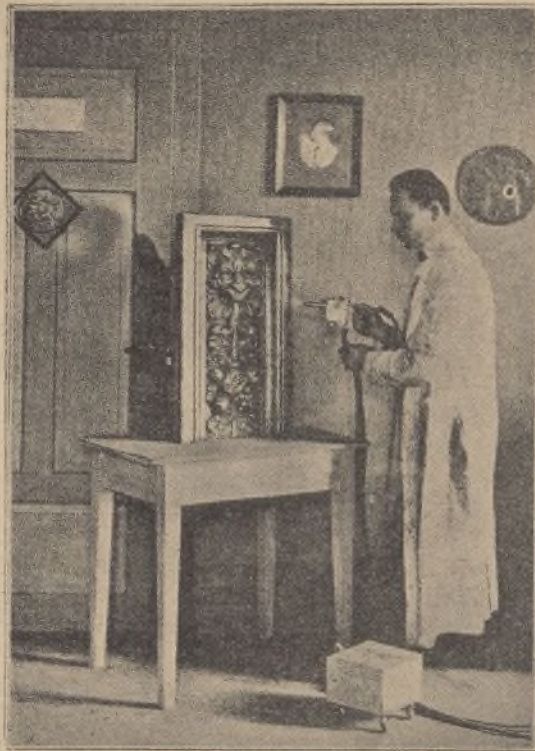
Fig. 4.—Operación del chapeado por medio de la pistola.
