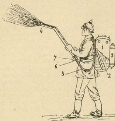
Diseño I.—Soldado provisto con el aparato para lanzar líquidos inflamables.
