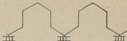
Fig. 101.—Devanado en onda a una vuelta por segmento.
