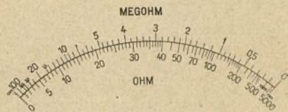
Fig. 3.—Escala del contador de megohmios.
