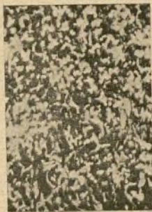
Fig. 14.—Hierro fundido gris. Amplificado 80 diámetros y reducido de un tercio. Atacado por ácido pícrico.
