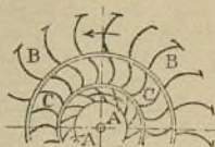
Fig. 5.—Disposición de las aletas para dos ejes girando en sentido contrario.
