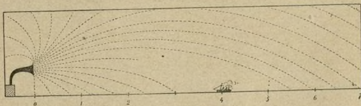
Fig. 1.—Zona de opacidad acústica dentro de una atmósfera ópticamente limpia. A cuatro millas marinas de la sirena, el buque no percibe el sonido mientras que las ondas sonoras se propagan mucho más lejos. Ello es debido a una masa de vapor de agua completamente invisible que forma pantalla sobre el camino de las vibraciones acústicas.
