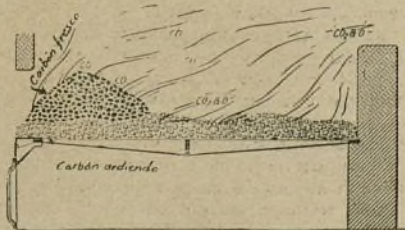
Fig. 4.—Conversión del carbón en coke en la placa muerta.
