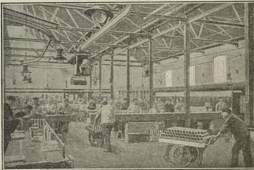
Comprobación del calibre de los obuses en el taller de proyectiles.
