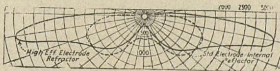
High Eff., etc. — Electrodo de alta eficacia y refractor. Std. Electrode, etc. — Con electrodo ordinario y reflector interno.
