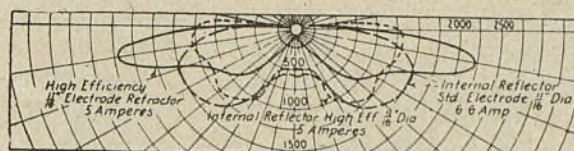
High Efficiency, etc. — Con electrodo de gran eficacia de 16,5 mm. y refractor. — 5 amperios. Internal Reflector, etc. — Con electrodo de alta eficacia de 16,5 mm. y reflector interno. — 5 amperios. Internal Reflector Std., etc. — Con electrodo ordinario de 16,5 mm. y reflector interno. — 6,6 amperios.
