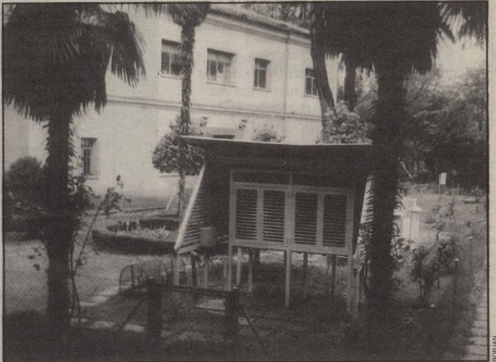
Termómetro del Observatorio del Retiro preparado cuidadosamente para medir la temperatura del aire
