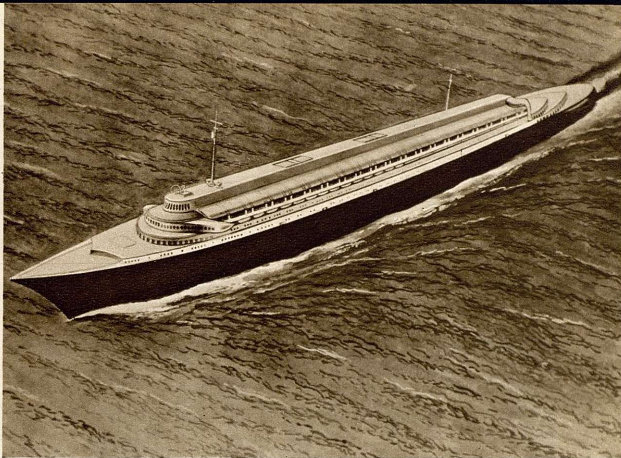
Un dibujo del transatlántico que se proponen construir las Líneas Francesas para rebasar en velocidad y en tamaño a los demás existentes. El barco tendría 500 metros de longitud, velocidad de 37 nudos, tardaría tres días y medio en cruzar el océano... y no tendría chimeneas.
