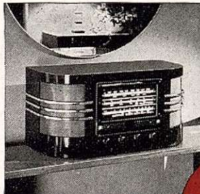
Modelo 8Q4 —Cerebro Mágico de 4 bandas y 8 tubos, Ojo Mágico, un paso de r-f, parlante de 20 cm., control automático de volumen, 150 a 22,000 kcs.
