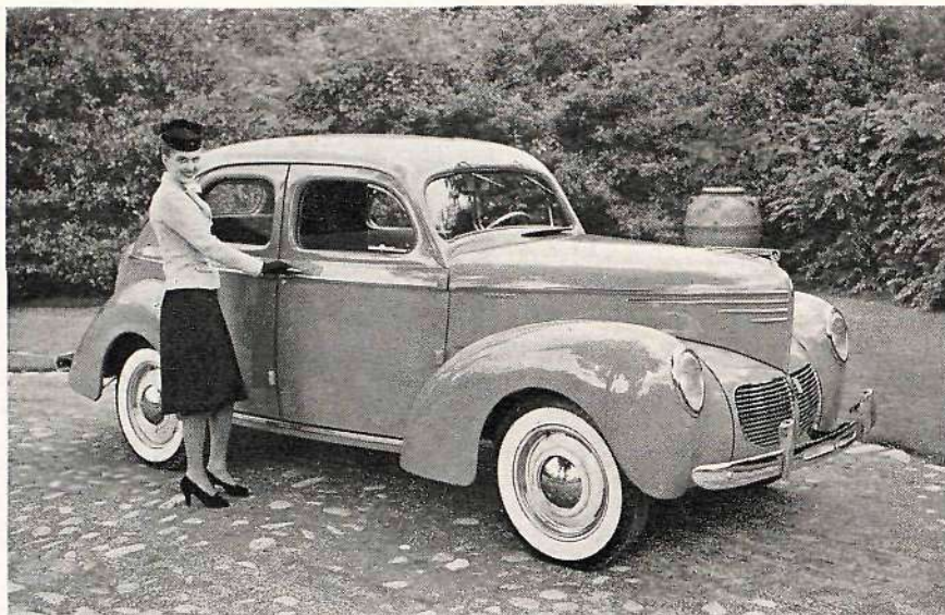
El modelo se sedán Willys para 1940, cuyo estilo se diferencia de los de coches anteriores de la misma marca. Esta novedad hace elegante su perfilamiento que alcanza al capó y a los amplios guardafangos. Los modelos De Luxe de este surtido tienen gobierno de ventilación. La carrocería es forjada de una pieza, toda de acero.
