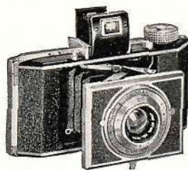
KODAK BANTAM —Objetivo Kodak Anastigmático Especial f/4.5; obturador de 4 velocidades hasta 1/200 seg.; visor óptico plegable. Negativo, 28 x 40 mm.
