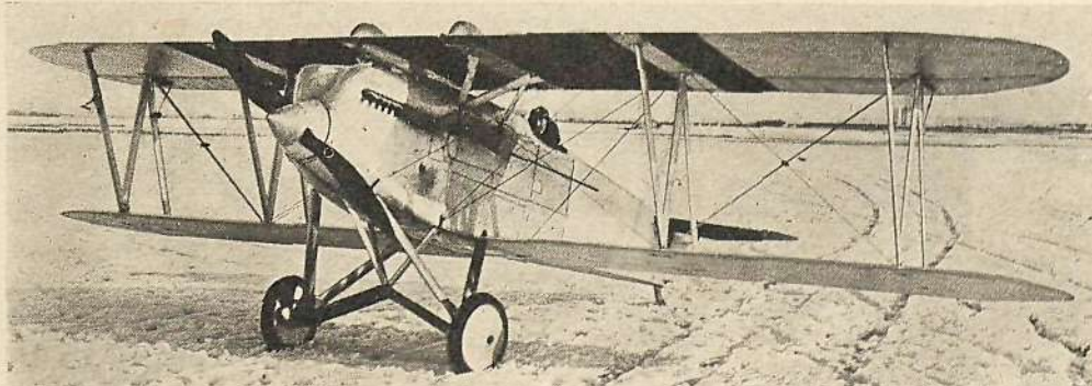
Aeroplano de persecución Curtiss, en que Maughan hizo su vuelo, con motor de esa marca "D-12" de 400 caballos y 2200 revoluciones por minuto. Tiene una embergadura de 32 pies y es de acero y madera, con alas de tela. Su velocidad normal es, al nivel del mar, de 169.9 millas por hora y de 160 a 3000 metros. El depósito de gasolina tiene capacidad para dos horas de vuelo. Si se le quitan la ametralladora, las municiones, la cámara fotográfica y los accesorios, disminuido el peso total de la máquina (que es de 2700 libras) pueden instalarse depósitos de reserva de agua y lubricantes y aumentar la cantidad de combustible.
