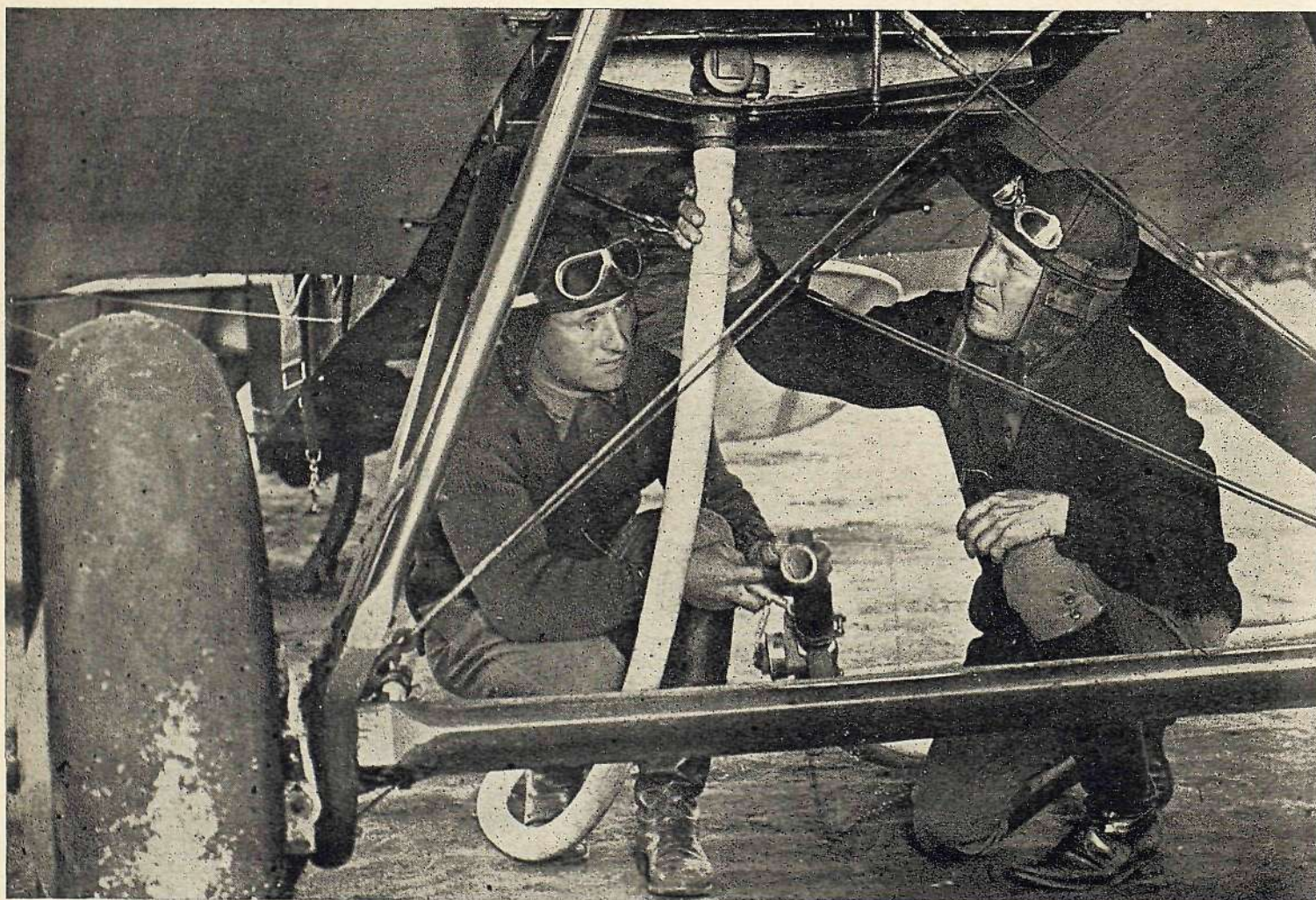
Los pilotos militares, Capitán Lowell H. Smith y Teniente John Ritcher, mostrando el sistema por el cual efectúase el cargamento de combustible de un aeroplano a otro durante el vuelo, a fin de no interrumpir los viajes aeronáuticos de gran duración. El gas y el aceite se transmiten de una a otra nave mediante una manguera, según se ve en la fotografía y cuando los dos aeroplanos — el que carga y el que recibe — marchan lado a lado a idénticas velocidades.
