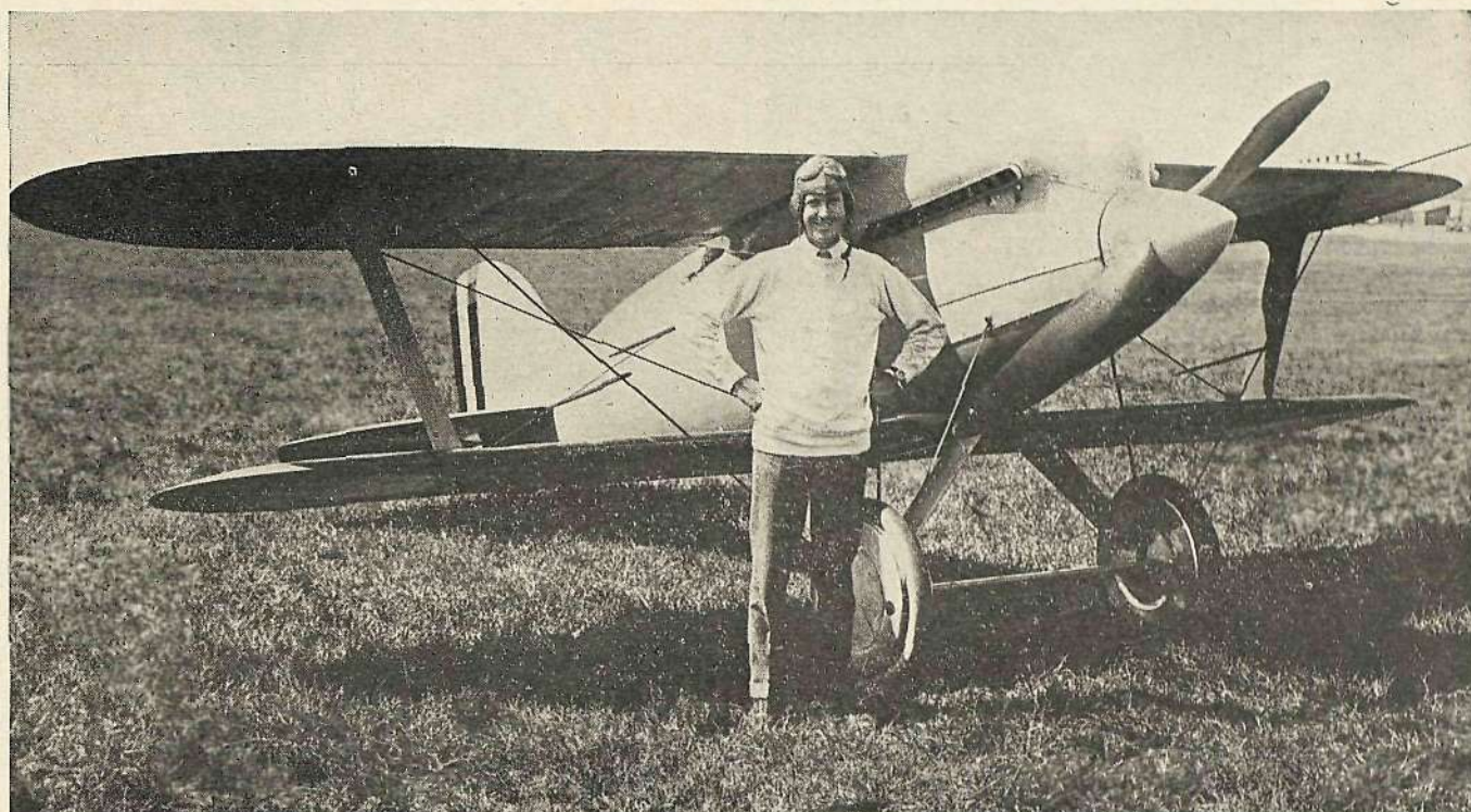
El aeroplano en el cual se alcanzaron las mayores velocidades a que un sér de la creación haya atravesado nunca los aires. Esta pequeña máquina Curtiss, de la Marina Norteamericana, sirvió a los aviadores Williams y Brow (aquí retratado) para volar sobre una extensión de un kilómetro a razón de 428 kilómetros por hora. La máquina tiene un motor de 500 caballos de fuerza y está construída especialmente para translaciones rápidas.
