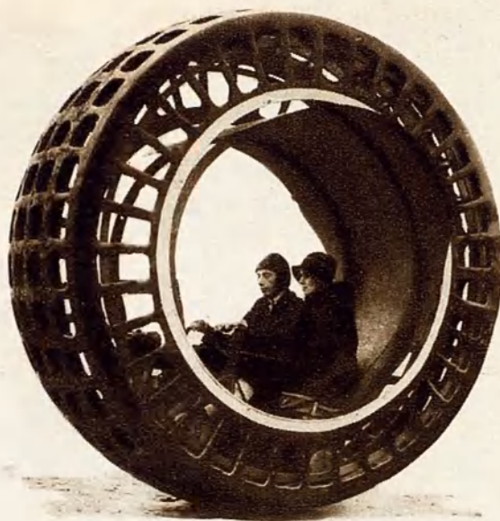
Novísimo aparato de "ciclismo" que inventó el inglés Pervis para avanzar por las carreteras—¡hay gente intrépida!—a razón de 25 millas por hora. Propulsa la singular rueda un motor de dos y medio caballos.
