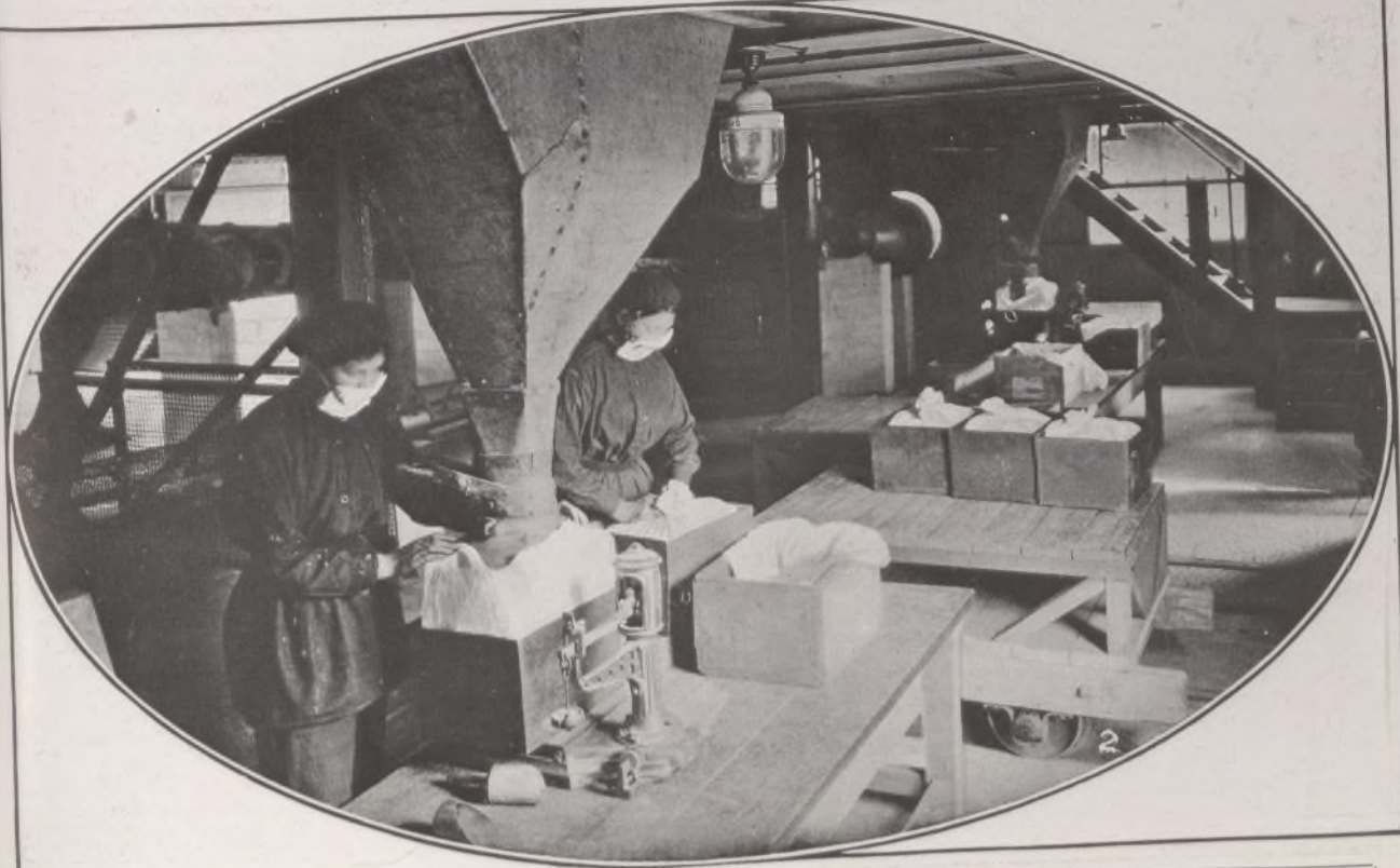
Secundando el esfuerzo de los mozos que están en el frente.— 1. Asegurando con anillos de cobre las bombas de metralla (shrapnel). 2. Embalando el explosivo T.N.T.
