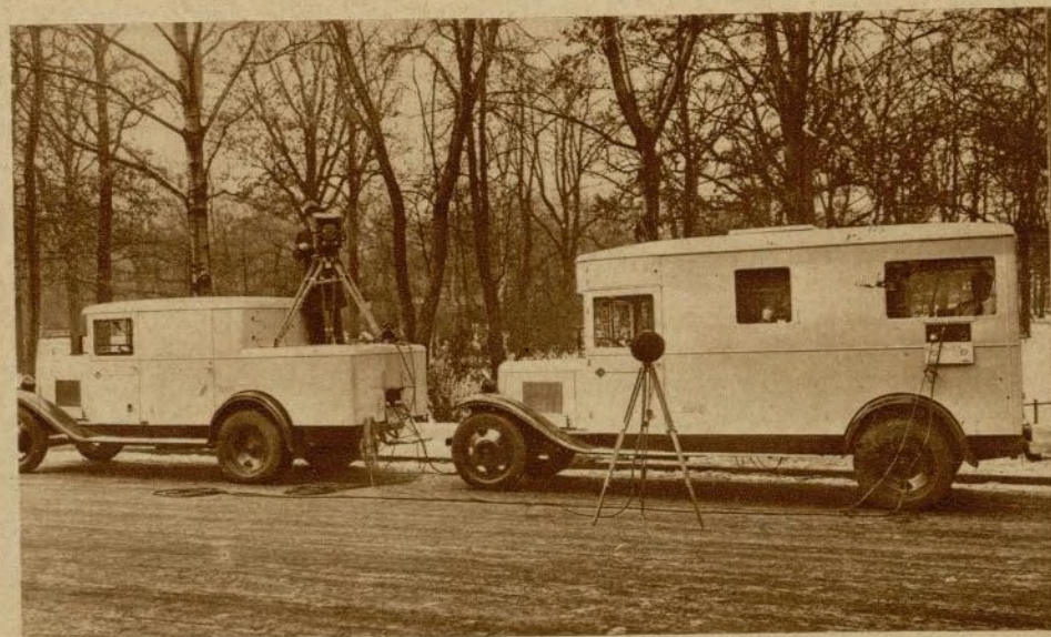
Equipo impresor Klangfilm. Ensta de dos vehículos. El coche para la impresión ya dotado de una cabina de control con pupitre de mezcla de sonidos y altavoz de control. Pueden utilizarse simultáneamente hasta cuatro micrófonos. Posee dos cámaras tomavistas. Y alcanzan de 60 a 80 kilómetros de velocidad.
