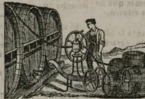
Bomba rotativa para el trasiego del vino; más apreciada que ninguna otra a causa de la sencillez y de la solidez de su mecanismo.
