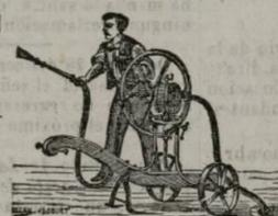
Bomba rotativa para el trasiego del vino; más apreciada que ninguna otra á causa de la sencillez y de la solidez de su mecanismo.
