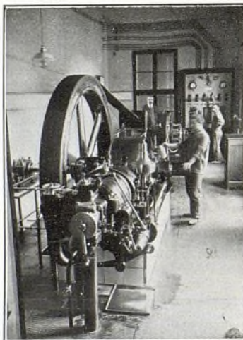
Motor de cincuenta caballos y dinamo eléctrica de la fábrica de los Sres. Colomer Huos.
