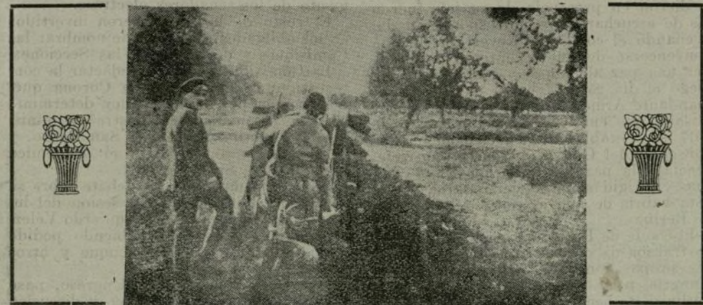
«Tractor Universal» roturando monte con arado bisurco a 25 centímetros de profundidad por 70 de anchura, y a una velocidad de 4 kilómetros por hora.
