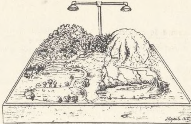
1.—Aparato para explicar en las escuelas el efecto de la lluvia en terreno con monte y desnudo
