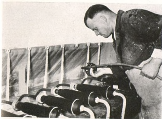
La viscosa se hace pasar por toberas con centenares de finísimos orificios al baño de hilado donde se producen las fibras
