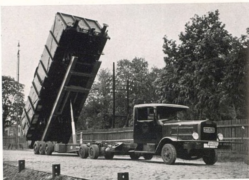
Camión con dispositivo bascular para cargar, descargar y transportar por las calles vagones de carga de ferrocarril
