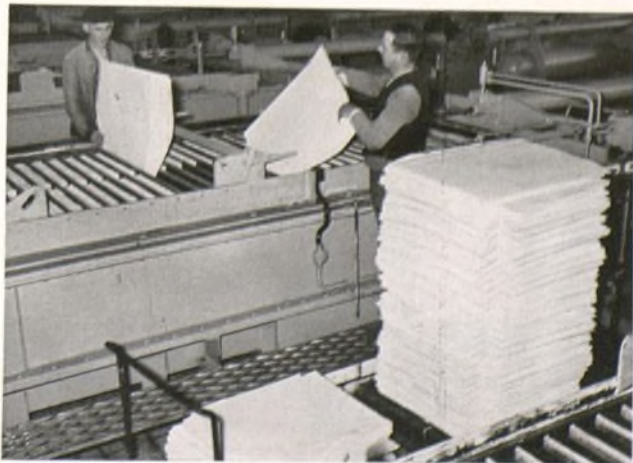
Las planchas de fibra de rayón se colocan en las prensas de inmersión para someterlas al tratamiento con legía de sosa cáustica
