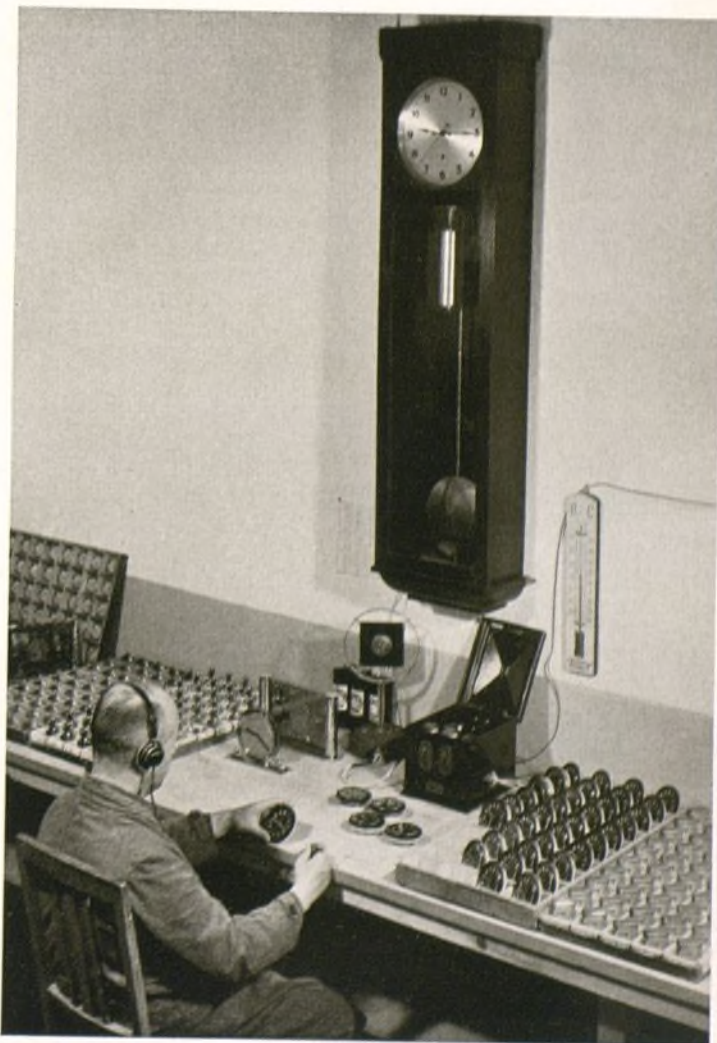
Verificando la marcha de los relojes por un reloj de péndola
