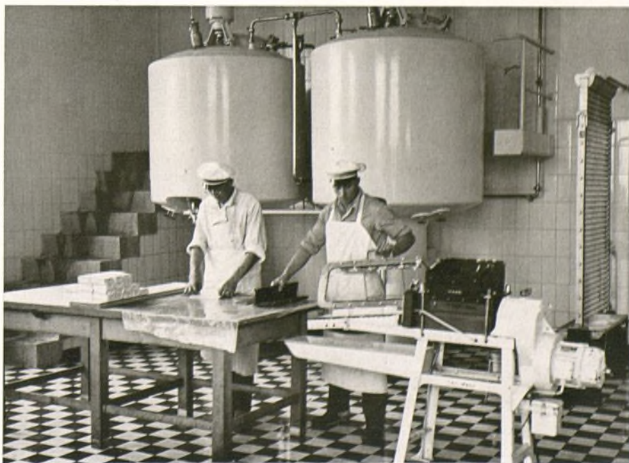
Fabricación de mantequilla en una moderna empresa de lechería cerca de Berlín: al frente, a la derecha, una máquina para moldear la mantequilla; al fondo, dos depósitos para la maduración de la crema, de 2000 litros de capacidad cada uno, con su respectiva instalación de refrigeración y calefacción
