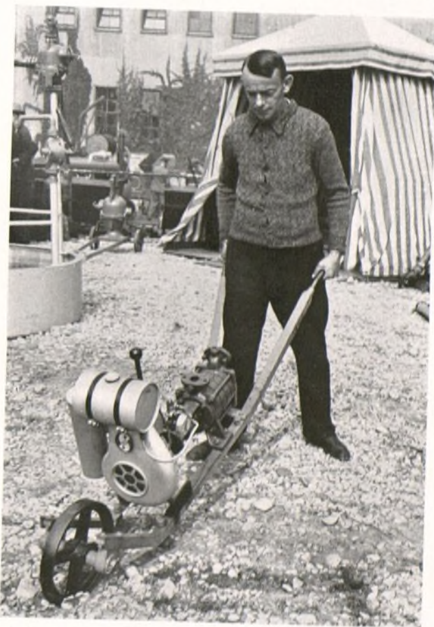
Feria de Leipzig — Una práctica bomba transportable con motor a gasolina
