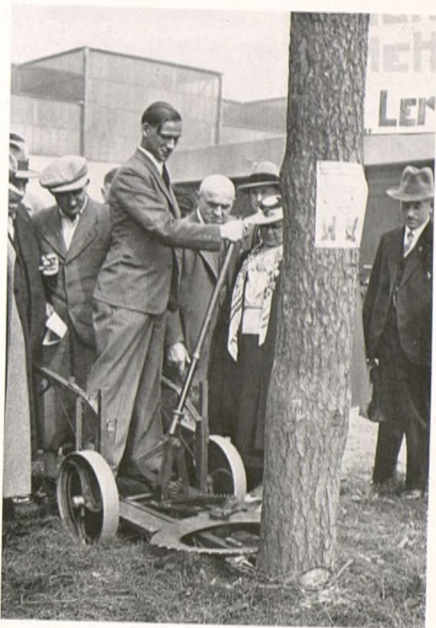
Feria de Leipzig — Una nueva máquina taladora que ahorra gran cantidad de madera, porque el corte se efectúa mucho más abajo que talando a mano
