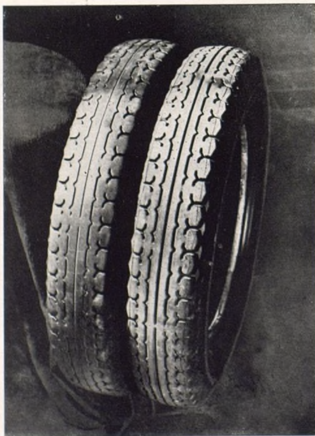
Estos dos neumáticos, de los cuales el izquierdo es de goma natural y el derecho de Buna, fueron usados en el mismo coche bajo las mismas condiciones e indican claramente la resistencia mayor y el desgaste menor del producto sintético
