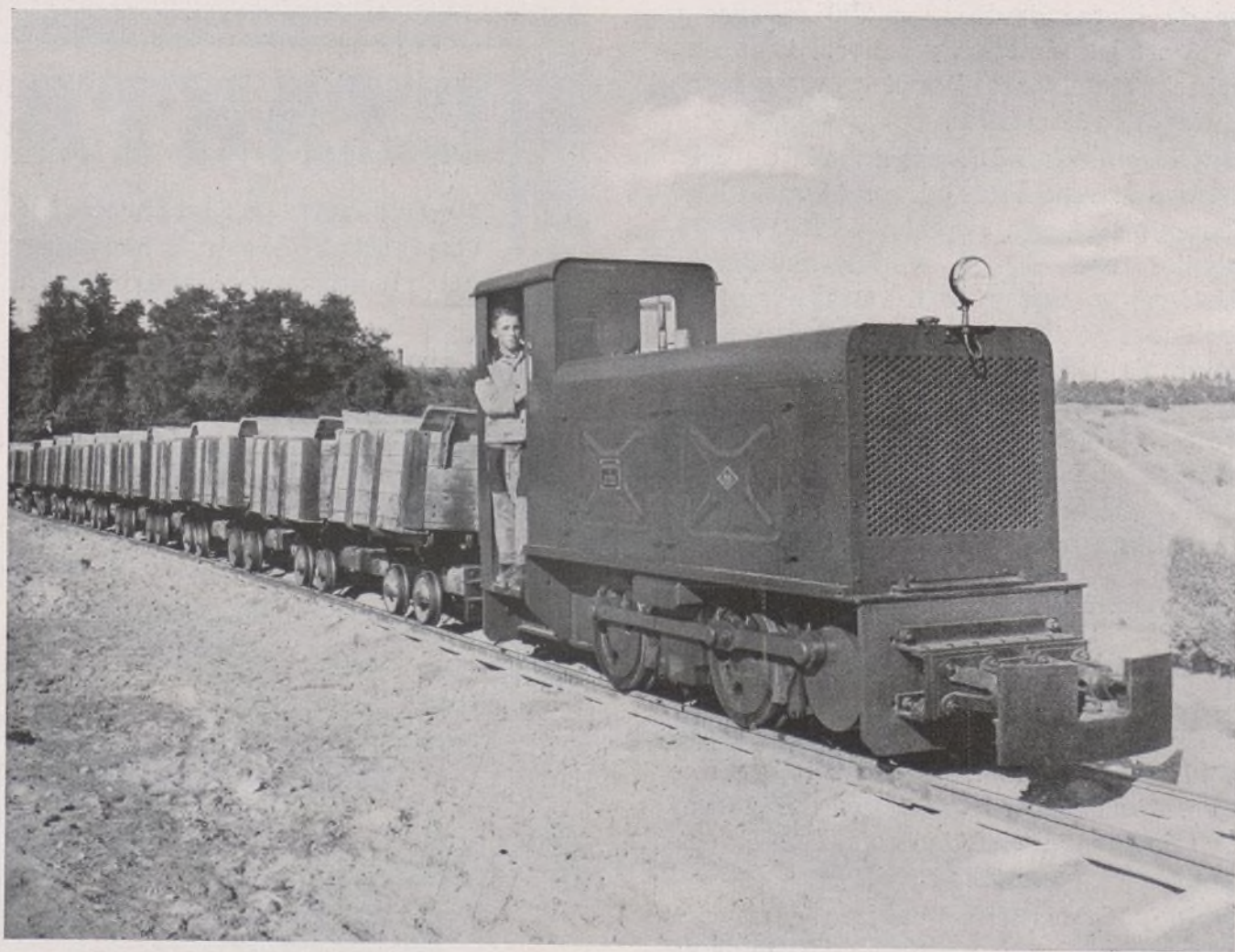
Locomotora a motor Diesel, de 70/75 CV
