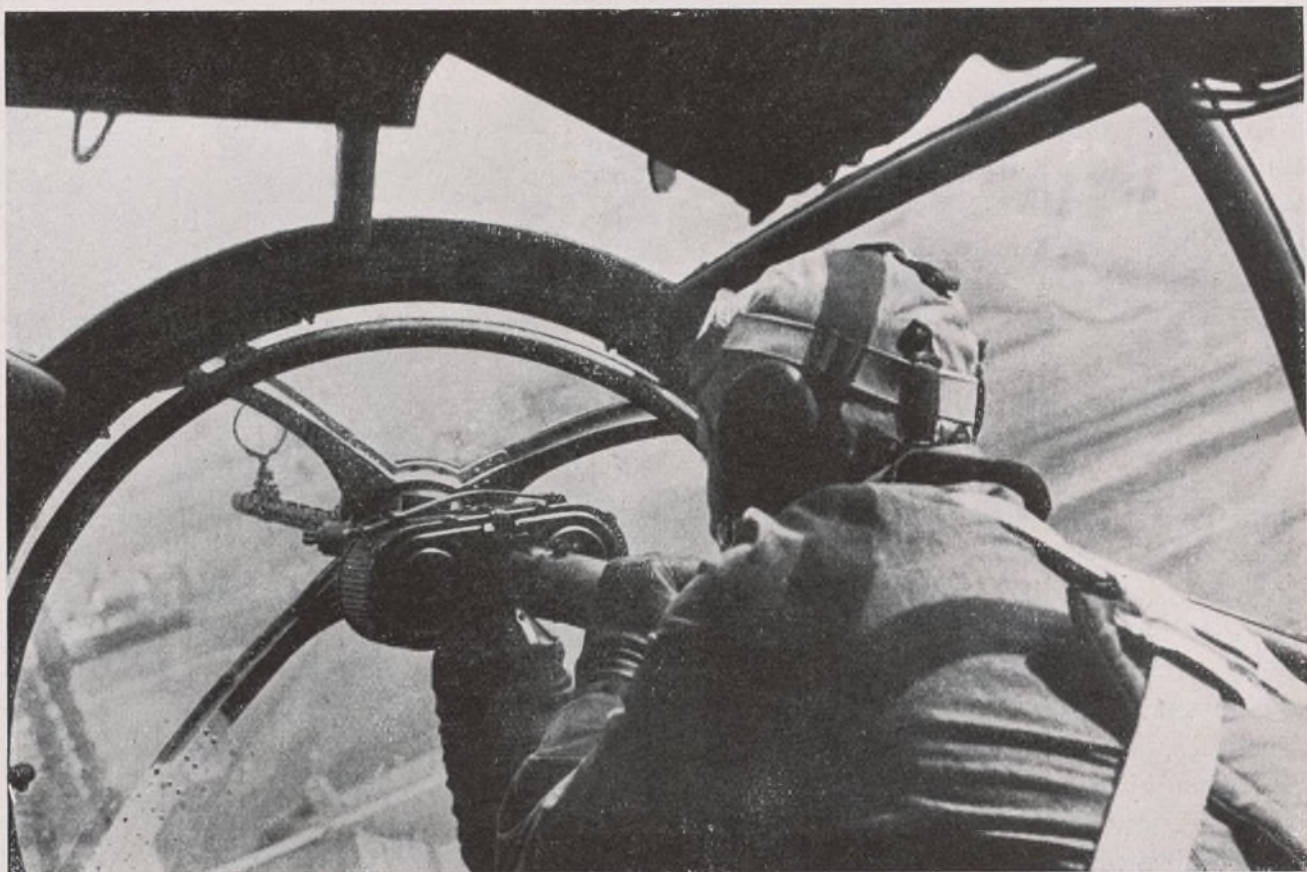
Tirador en el puesto de la ametralladora de proa de un avión Heinkel He 111, manejando la ametralladora suspendida en Cardán dentro de una cúpula móvil de vidrio Plexi
