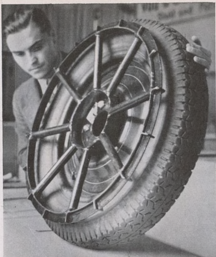
Feria de Leipzig de Otoño 1940: Una nueva rueda de agarre para impedir que el automóvil patine en carreteras en mal estado
