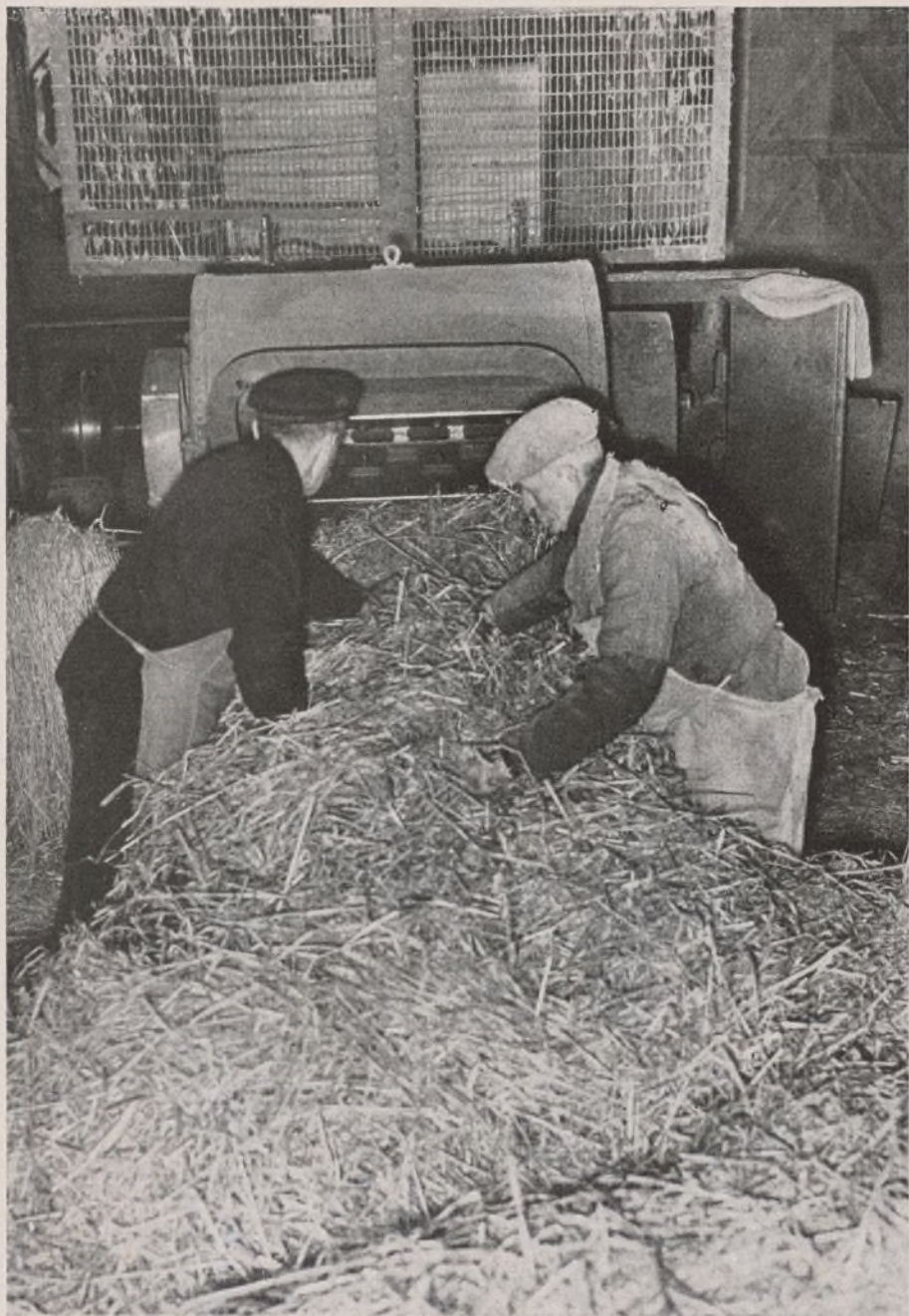
Fabricación de celulosa: La paja se echa a la máquina cortadora a fin de prepararla para el hervidor
