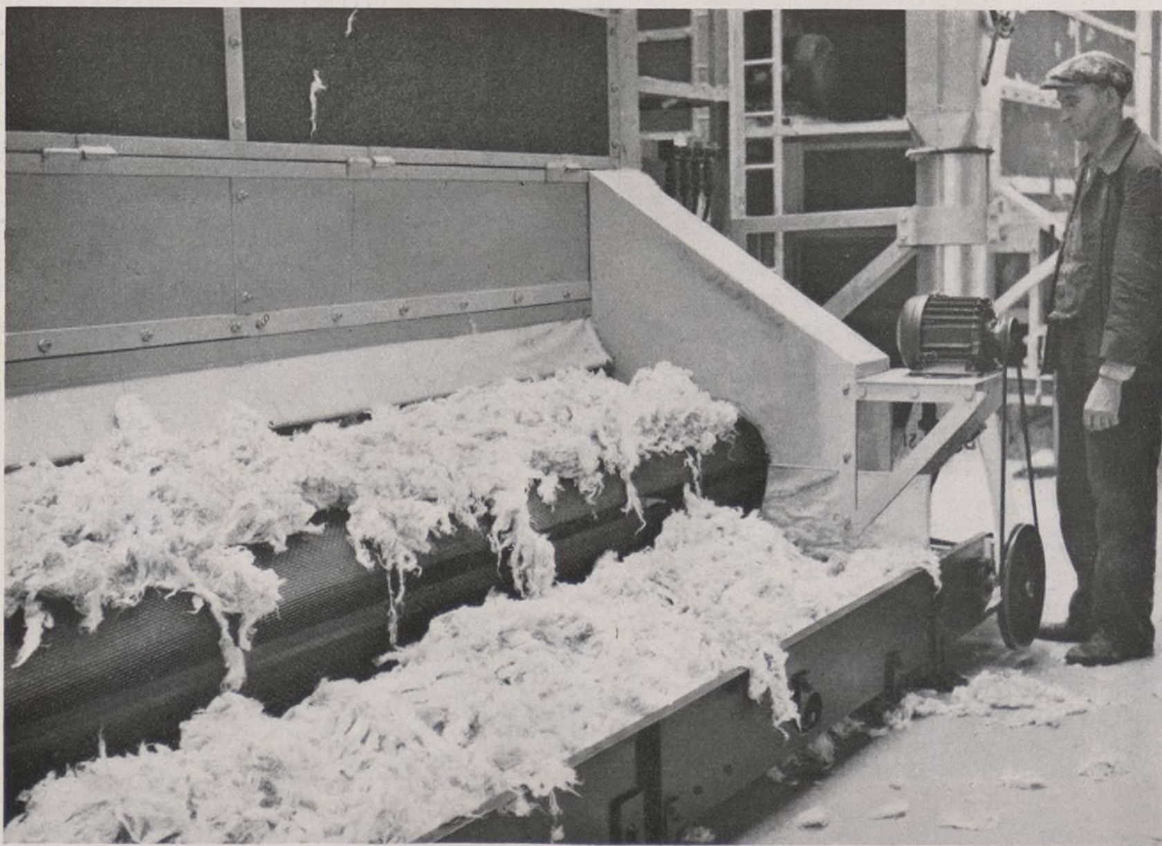
Fabricación de celulosa: La lana celulosa sale del secador
