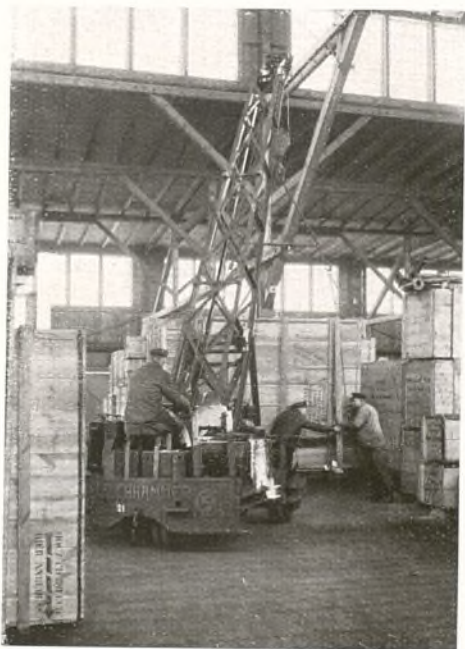
Apilando cajones pesados en un almacén mediante una grúa especial
