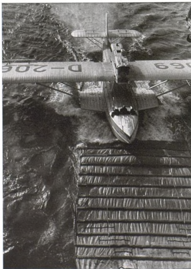
El hidroavión subiendo a la rampa-varadero removable de lona impermeable armada con vareta transversales
