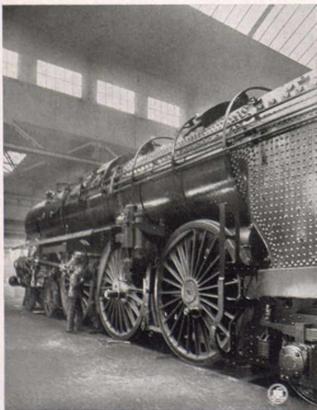
Montaje de una locomotora aerodinámica Borsig
