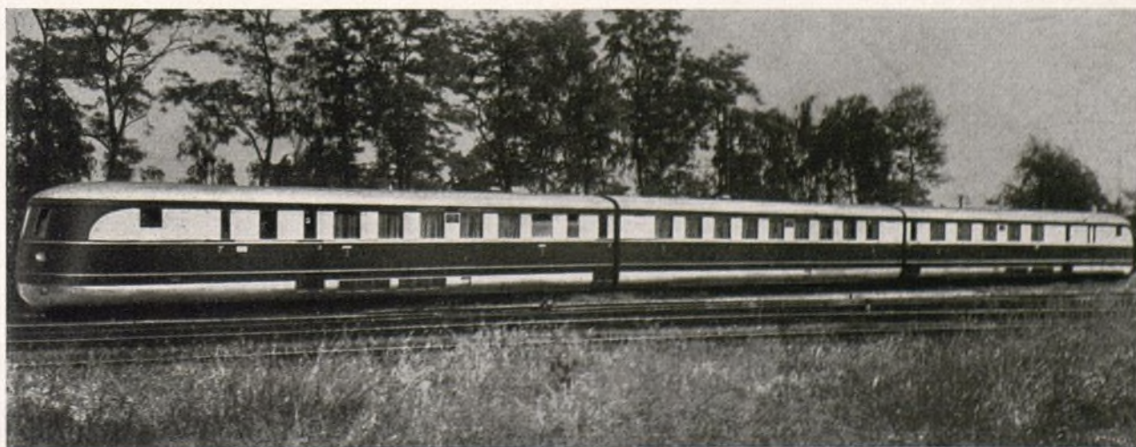
el 17 de Febrero de 1936: el feliz viaje de prueba del tren automotor rápido Diesel de tres partes que entre Berlín y Hamburgo alcanzó a casi 205 km./hora de velocidad
